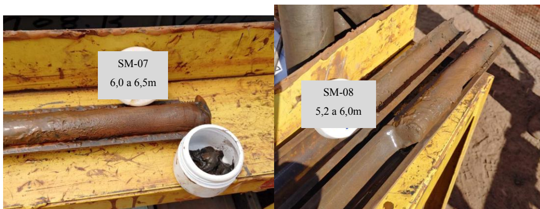
Figura 49 – Rejeito identificado pelas sondagens mistas SM-07 e SM-08, respectivamente.
