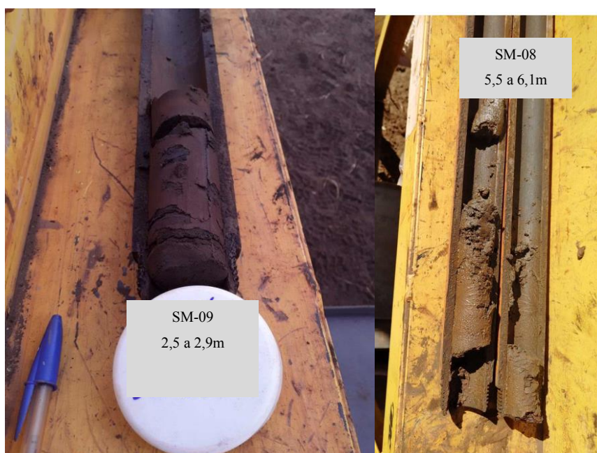
Figura 50 – Rejeito identificado pelas sondagens mistas SM-09 e SM-08, respectivamente.
