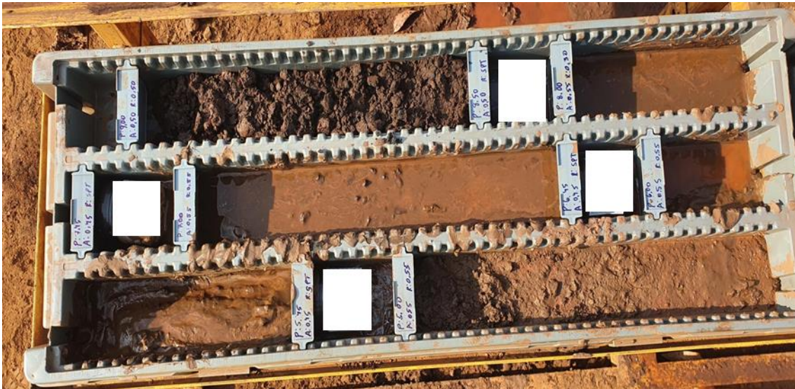
Figura 43 – Testemunhos dos rejeitos entre 10 e 15m do SM-03.
