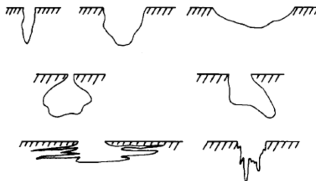
Figura 11 - Várias formas de pite segundo a ASTM.
