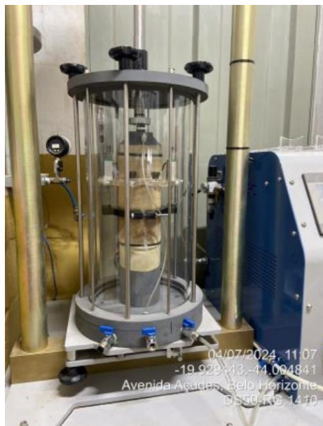
Figura 36 – Ensaio triaxial para obtenção de módulo de resiliência nas misturas
