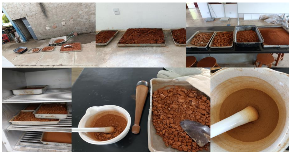
Figura 23 – Preparação do solo coletado para realização dos ensaios de caracterização
