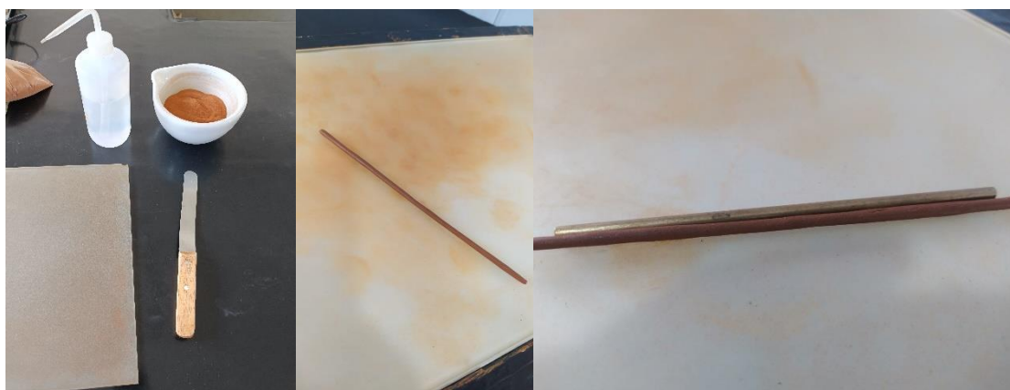
Figura 28 – Ensaio de Limite de plasticidade do solo
