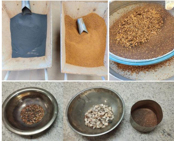
Figura 32 – Ensaio de granulometria nas misturas
