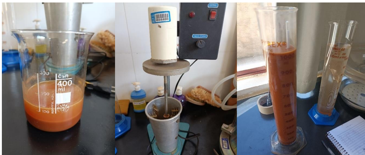
Figura 25 – Ensaio de sedimentação do solo
