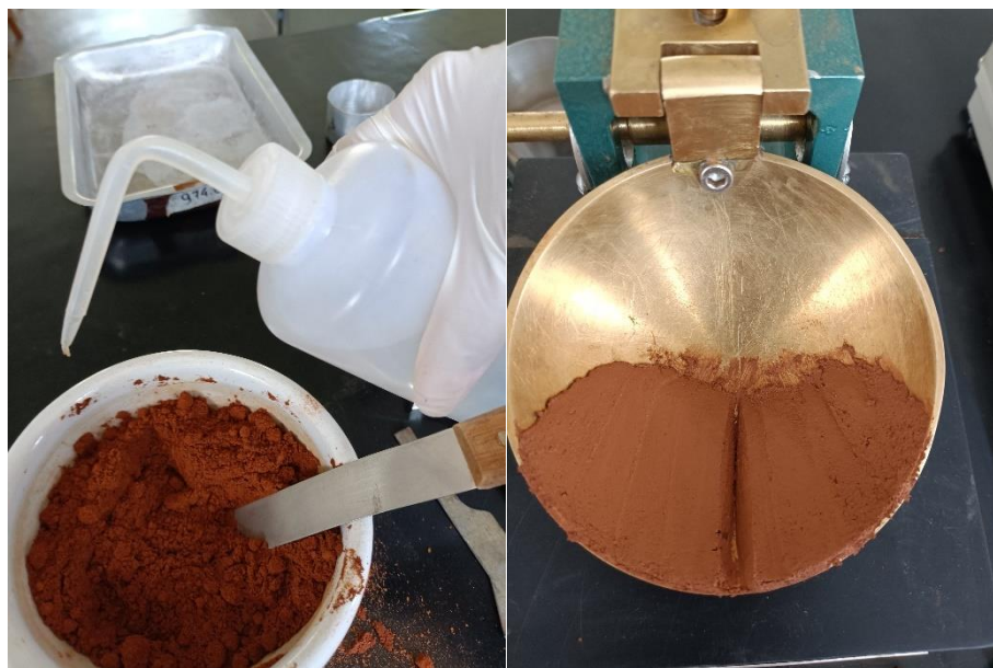
Figura 27 – Ensaio de Limite de liquidez do solo
