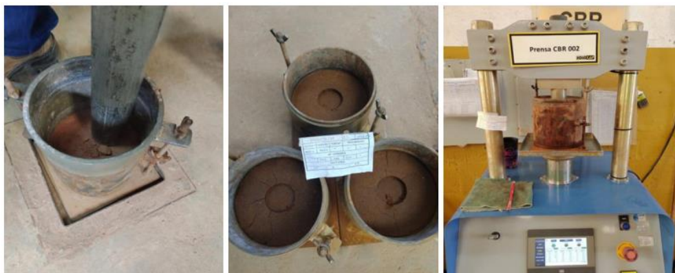
Figura 34 – Ensaio CBR nas misturas
