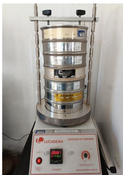
Figura 24 – Ensaio de peneiramento do solo
