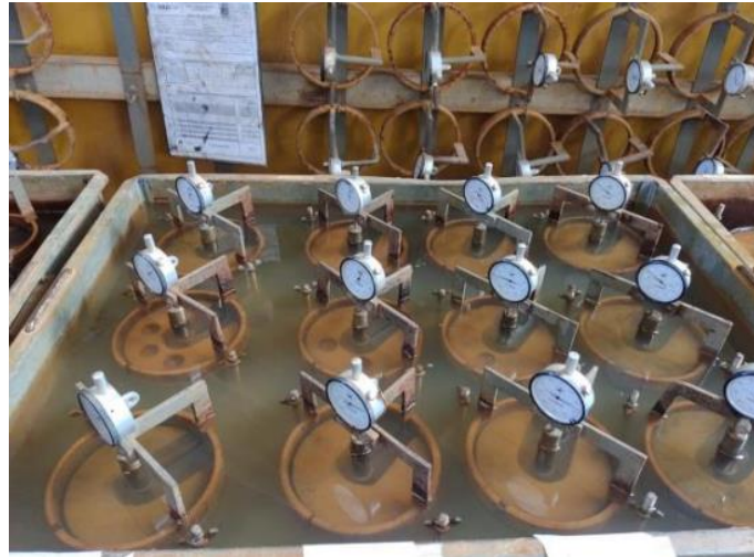
Figura 35 – Ensaio de expansividade nas misturas
