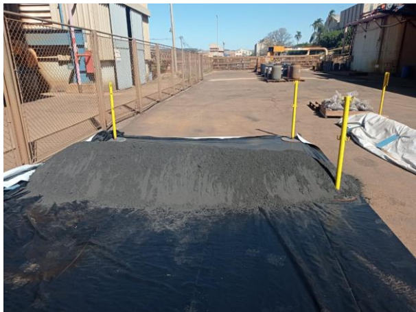
Figura 18 – Rejeito de magnetita coletado e preparado para fornecimento
