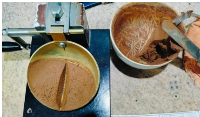
Figura 33 – Ensaio de limite de liquidez nas misturas
