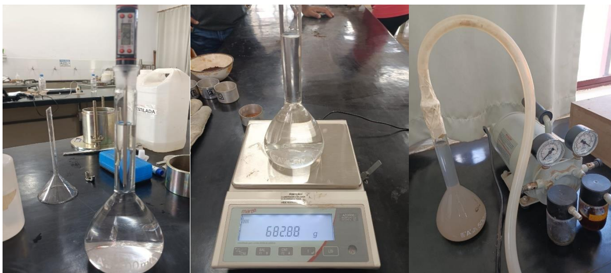
Figura 26 – Ensaio de determinação massa específica dos grãos do solo
