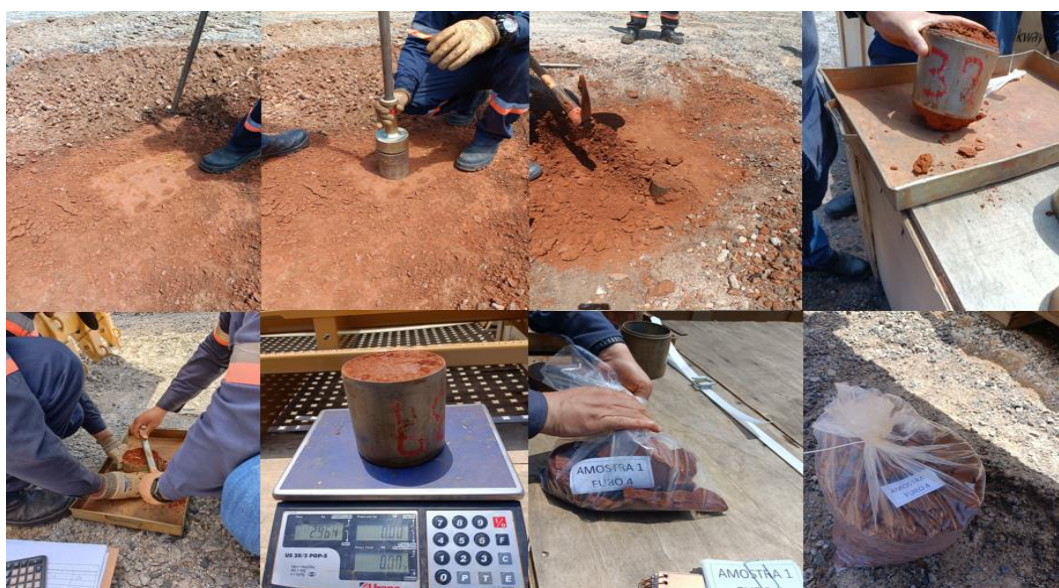
Figura 21 – Coleta de solo por meio de abertura de trincheiras e cravação de cilindros.
