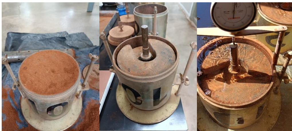
Figura 29 – Ensaio de Expansividade do solo.
