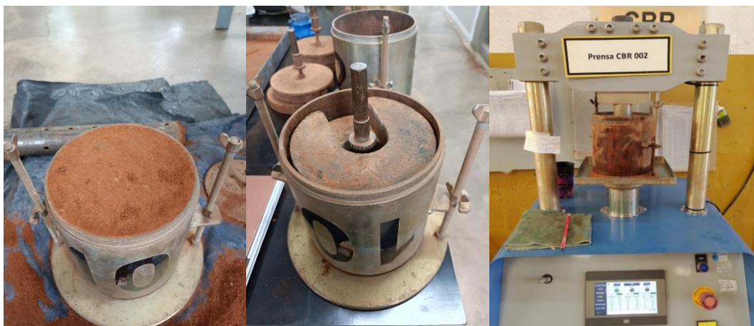
Figura 30 – Ensaio de Índice de Suporte Califórnia do solo
