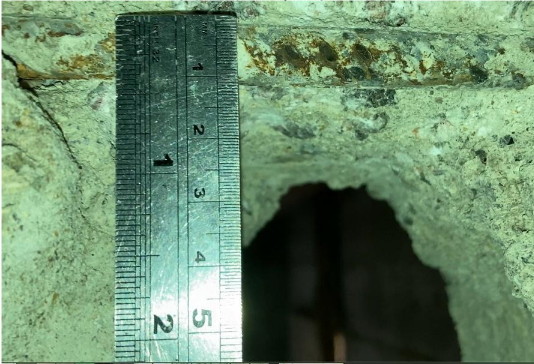
Figura 8: Área de aço longitudinal.
