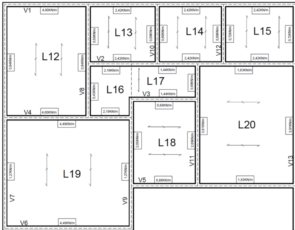
Figura 11: Reações de laje em cada segmento das vigas do segundo pavimento.
