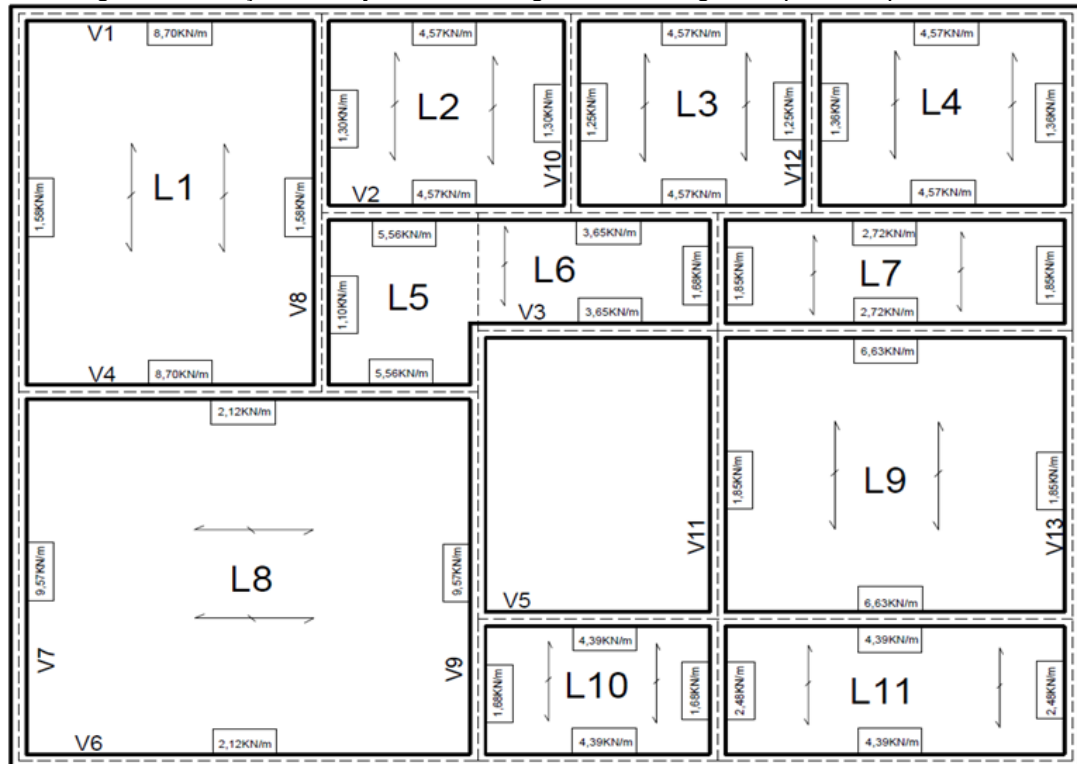
Figura 10: Reações de laje em cada segmento das vigas do primeiro pavimento.
