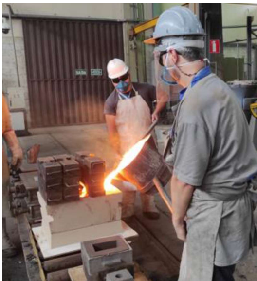
Figura 24 - Vazamento do metal no molde
