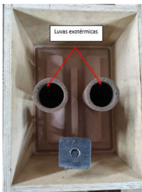
Figura 22 - Moldagem dos corpos de prova
