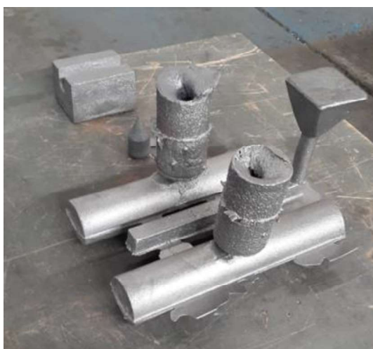
Figura 25 - Corpo de prova de usinabilidade e tração
