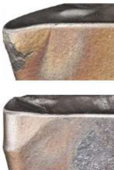
Figura 11 - Deformação plástica de ferramenta de corte
