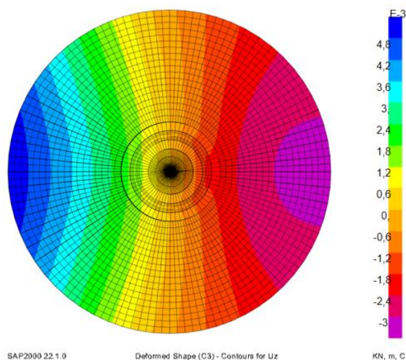
Figura 27 - Deslocamentos verticais sapata plana convencional – k_{\text{solo}}=55\text{MN/m}^3 – C3
