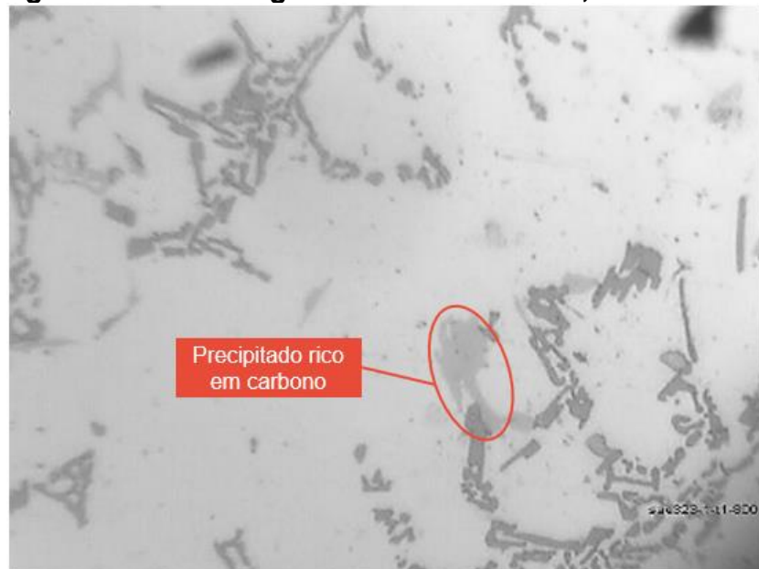
Figura 40 – Morfologia da amostra de Al-1,0%GNP 800x.
