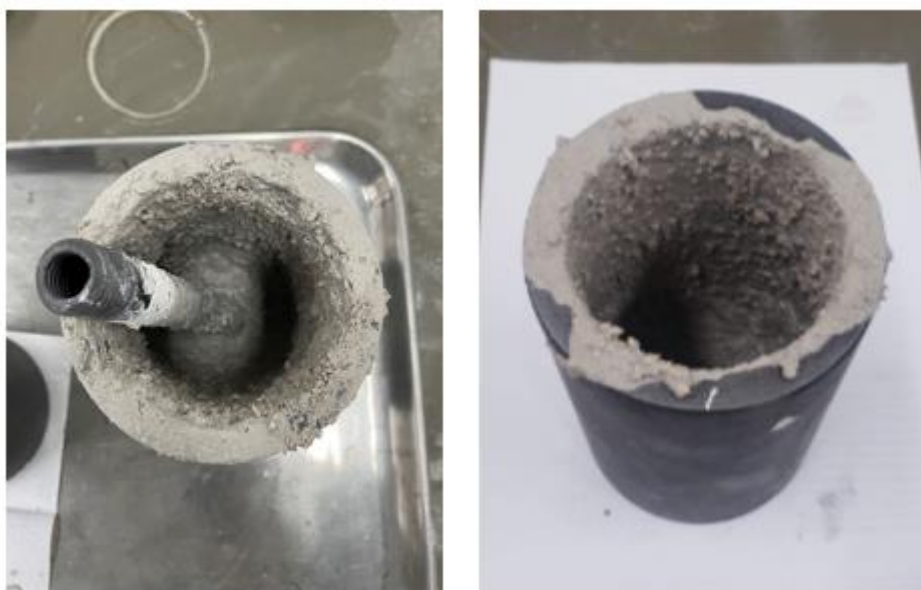
Figura 56 – Revestimento do Cadinho com Concreto Refratário.
