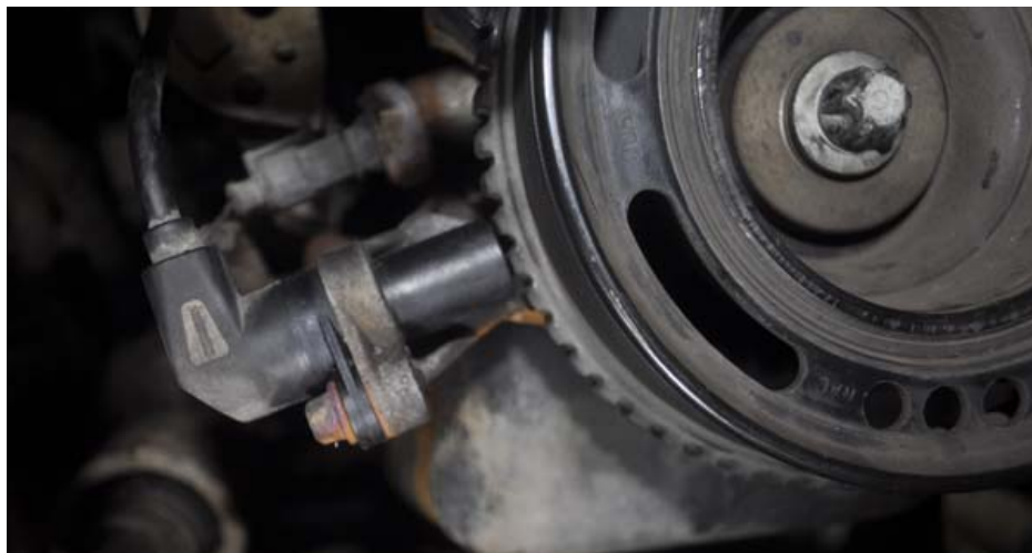
Figura 2.6: Exemplo de um sensor de rotação e seu posicionamento junto ao disco dentado em um MCI
