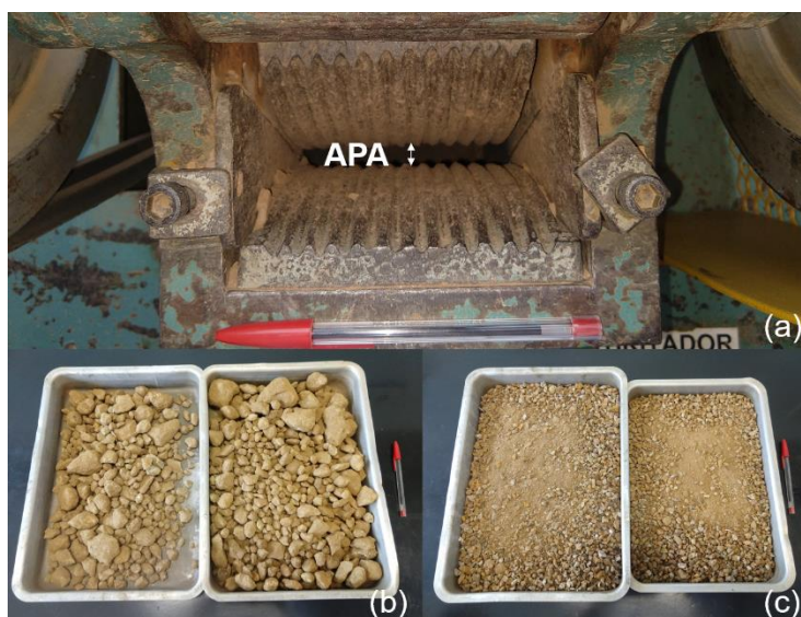
Figura 12 - Britagem (a) APA do britador; (b) Minério antes da britagem; (c) Minério britado
