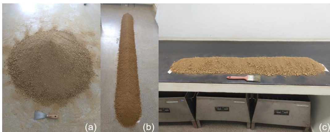
Figura 13 - Homogeneização e Quarteamento (a) Pilha cônica; (b) Pilha alongada de 4 m; (c) Pilha alongada de 1 m
