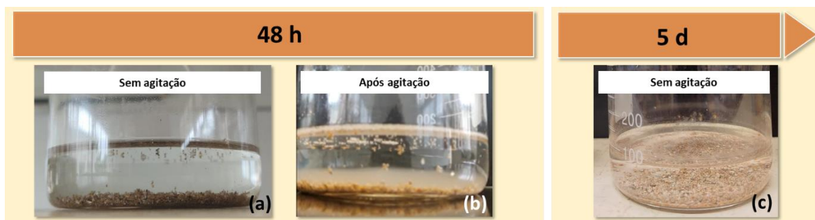
Figura 33 - Evolução da flotação reativa para a faixa -20# +65# para 100 ml de \text{H}_2\text{SO}_4 3% (v/v) e PVA 1% (m/v) (a) Após 48 h sem agitação; (b) Após 48 h com agitação; (c) Após 5 dias
