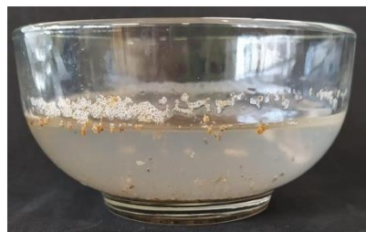
(10) -20# +65#, Ácido sulfúrico 5% (v/v), PVA 1% (m/v)
