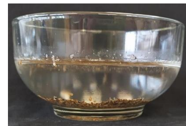
(12) -20# +65#, Ácido fosfórico 5% (v/v), PVA 1% (m/v)
