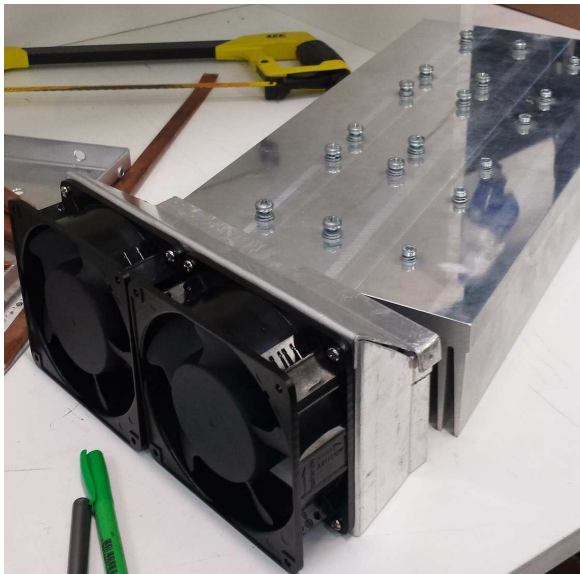
a) Acoplamento do ventilador, furos e roscas no dissipador.
