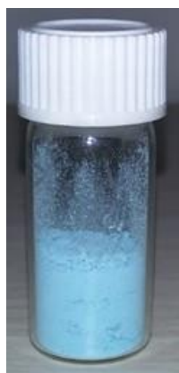
Figura 27. MOFCu sintetizada a partir dos precursores bdc e cobre(II)
