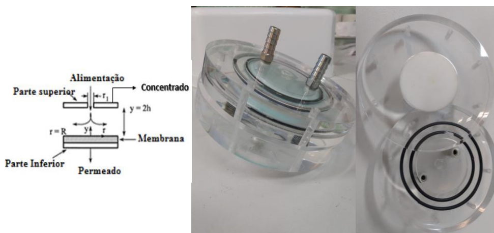
Figura 26. Célula de acrílico utilizada nos ensaios de permeação
