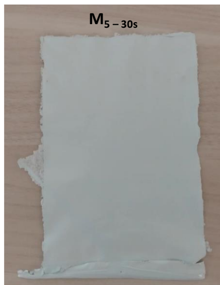
Figura 32. Membrana híbridas M_{5-30s} sintetizada no tempo 30 segundos
