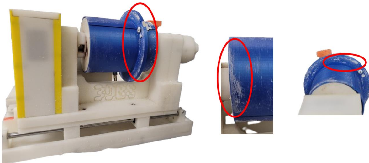
Figura 24 – Fibras eletrofiadas depositadas em partes isolantes.
