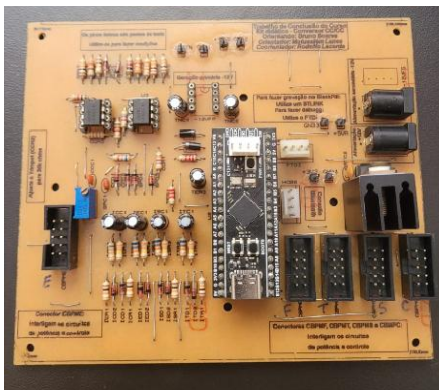
Figura 52 - Placa de Controle do Conversor CC-CC.
