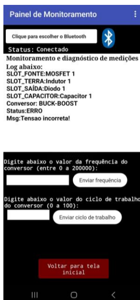
Figura 75 - Exibição da falha de alimentação no aplicativo de monitoramento
