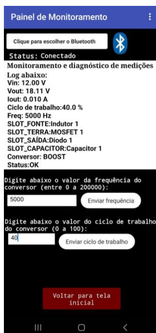
Figura 70 - Painel de monitoramento do aplicativo durante o funcionamento do conversor
