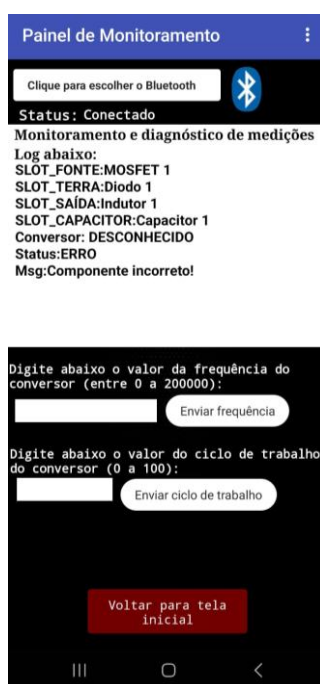
Figura 73 - Exibição da falha de montagem no aplicativo de monitoramento
