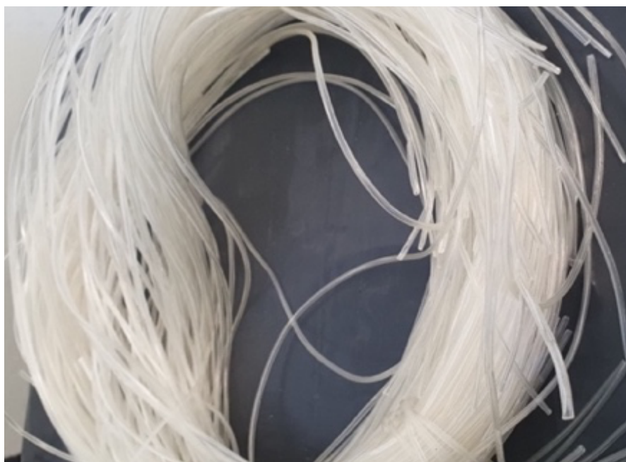
Figura 19 – Membranas de ultrafiltração na conformação de fibra oca
