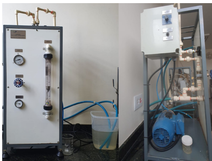
Figura 25 - Sistema de filtração para ensaios de nanofiltração; a) vista frontal onde encontra-se a monômetro, válvula, rotâmetro e controle de temperatura; b) vista lateral observado o controle de pressão e a bomba
