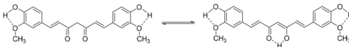
Figura 9- Reação de tautomerização ceto-enólico da curcumina
