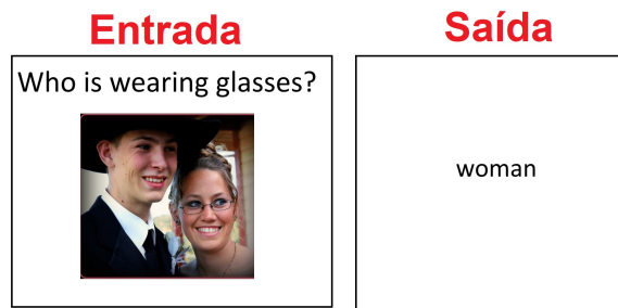
Figura 1 – Exemplo de entrada e saída em um sistema de VQA, no qual a entrada consiste em uma imagem e uma pergunta, enquanto a saída corresponde à resposta gerada para a pergunta referente a imagem.
