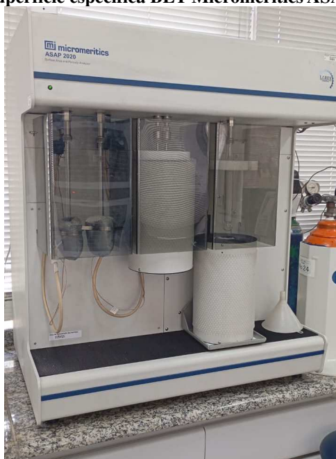
Figura 30 – Analisador de superfície específica BET Micromeritics ASAP 2020 utilizado na pesquisa
