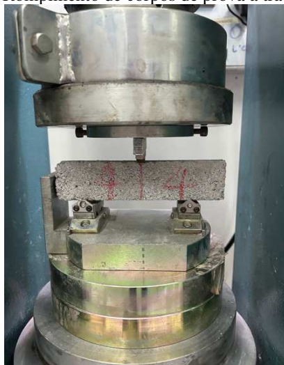
Figura 35 – Rompimento de corpos de prova a tração na flexão
