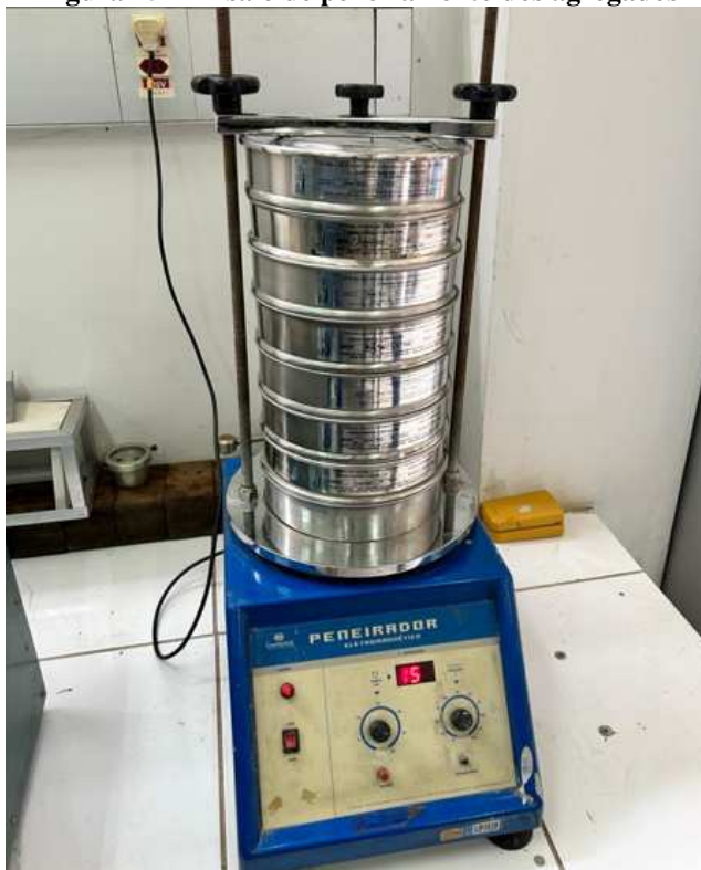
Figura 25 – Ensaio de peneiramento dos agregados
