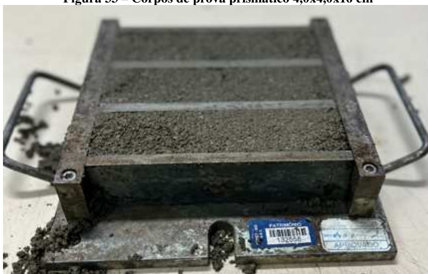
Figura 33 – Corpos de prova prismático 4,0x4,0x16 cm
