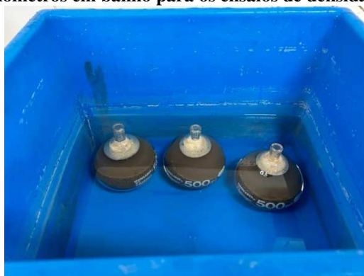
Figura 27 – Picnômetros em banho para os ensaios de densidade dos agregados
