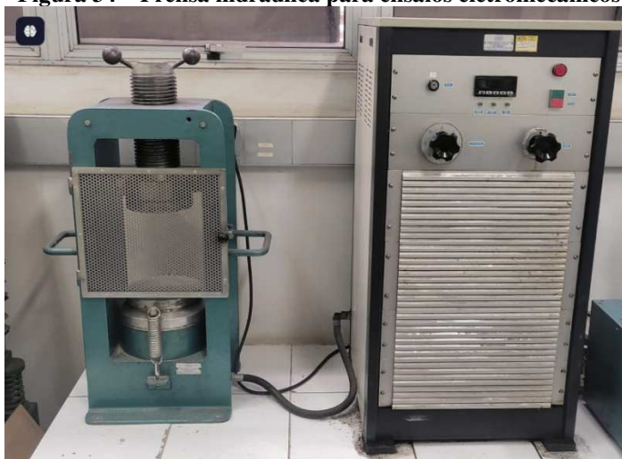
Figura 34 – Prensa hidráulica para ensaios eletromecânicos
