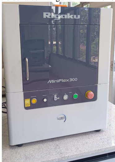
Figura 28 – Difratometro de raios X Rigaku – Miniflex 300 utilizado na pesquisa
