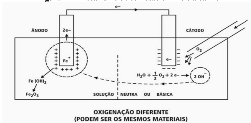
Figura 11 – Mecanismo de corrosão em meio alcalino
