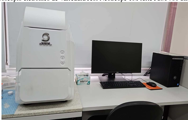
Figura 29 – Microscópio eletrônico de Varredura Jeol NeoScope TM série JCM 700 utilizado na pesquisa
