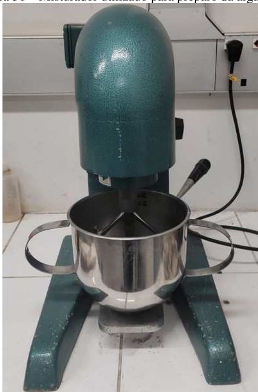
Figura 31 – Misturador utilizado para preparo da argamassa
