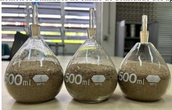
Figura 26 – Picnômetros utilizados no ensaio de densidade dos agregados e argila
