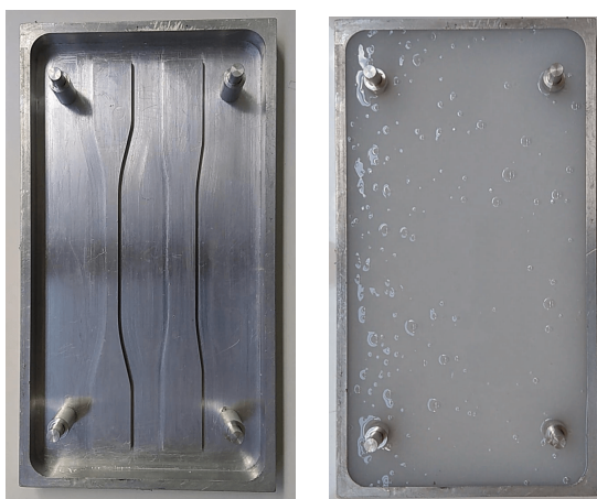
Figura 23 – Fabricação dos moldes (a) Modelo (b) Moldagem do silicone
