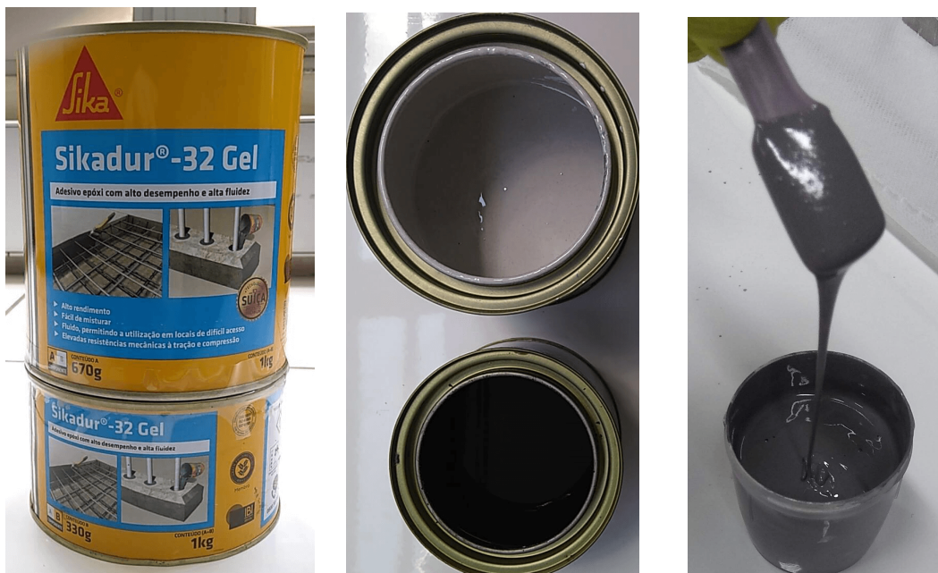
Figura 22 – Adesivo Sikadur® 32 Gel (a) embalagem do sistema epóxi (b) Aspecto superficial das partes A e B.
