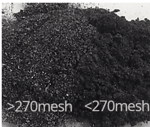
Figura 11 – Grafite passante (direita) e não passante (esquerda) em uma peneira de 270mesh ( 53\mu\text{m} )
