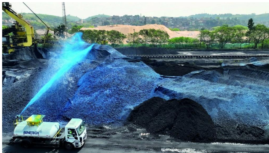
Figura 2: Aspersão de polímeros biodegradáveis em pilhas a céu aberto
