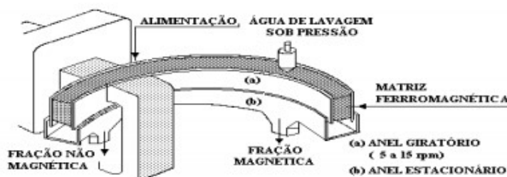
Figura 4 - Diagrama representativo dos separadores a úmido de alta intensidade de carrossel para circuito contínuo.
