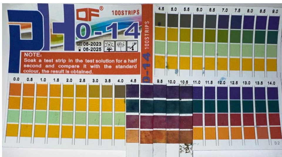
Figura 22: Comparação das fitas indicadoras de pH com a tabela de cores fornecida pelo fabricante.
