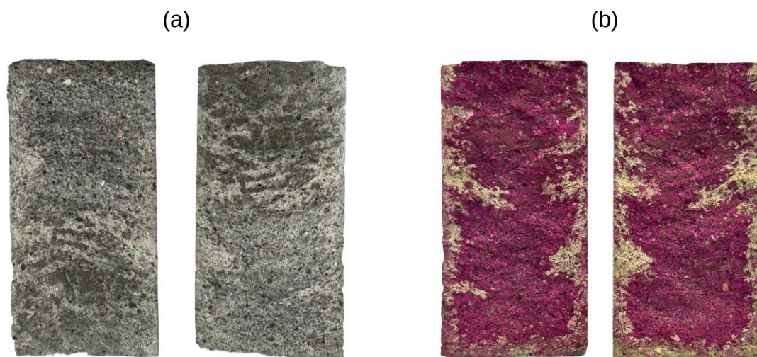
Figura 24: Amostra de argamassa rompida pelo ensaio de resistência à tração por compressão diametral (a) antes e (b) depois da aspersão de fenolftaleína.
