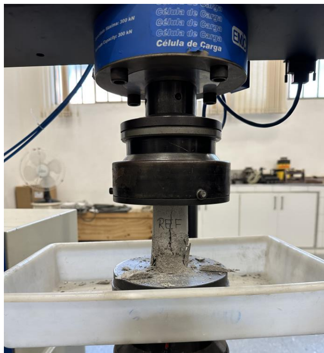
Figura 27: Ensaio de resistência à compressão axial realizado nas amostras de argamassas.
