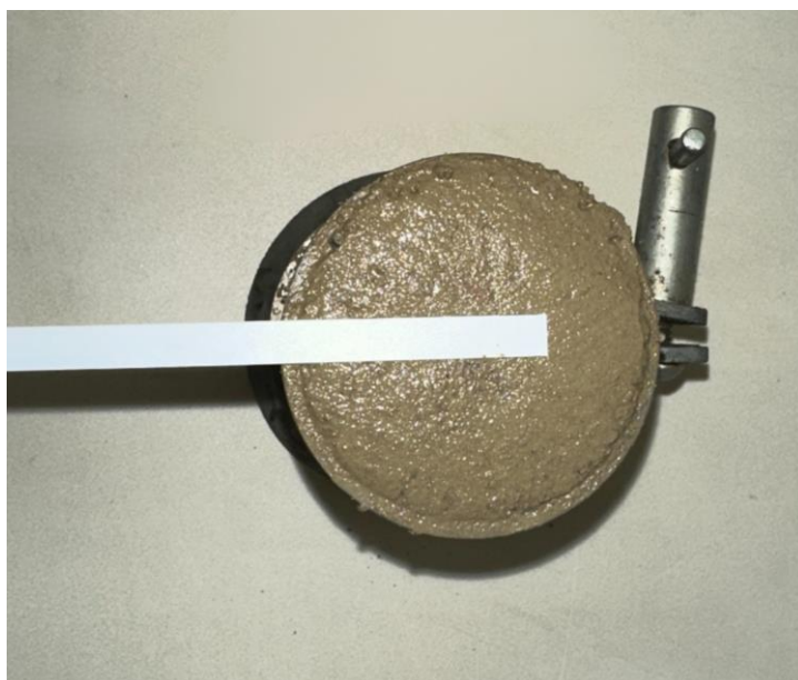
Figura 21: Medição do pH das argamassas com fita indicadora de pH.
