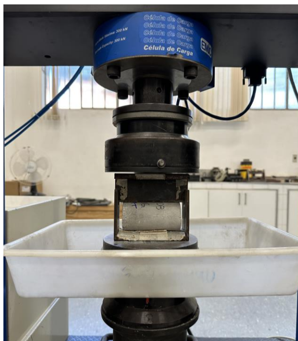
Figura 26: Ensaio de resistência à tração por compressão diametral realizado nas amostras de argamassas.
