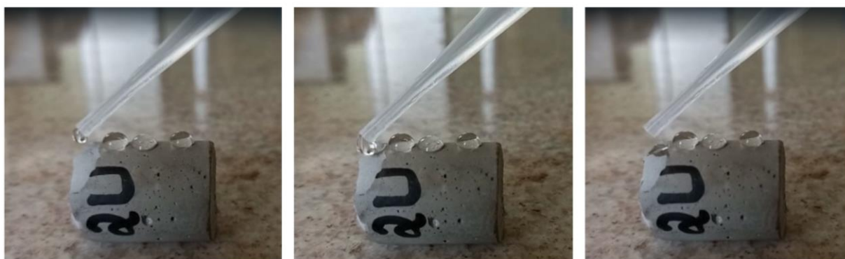
Figura 6. 4 – Gota d'água depositada sobre região subsuperficial (1,2 mm abaixo da superfície) de pasta de cimento revestida com sílica híbrida à base de MTMS. Amostra exposta por 45 dias às Condições Ambientes (Grupo CA) (Autora).
