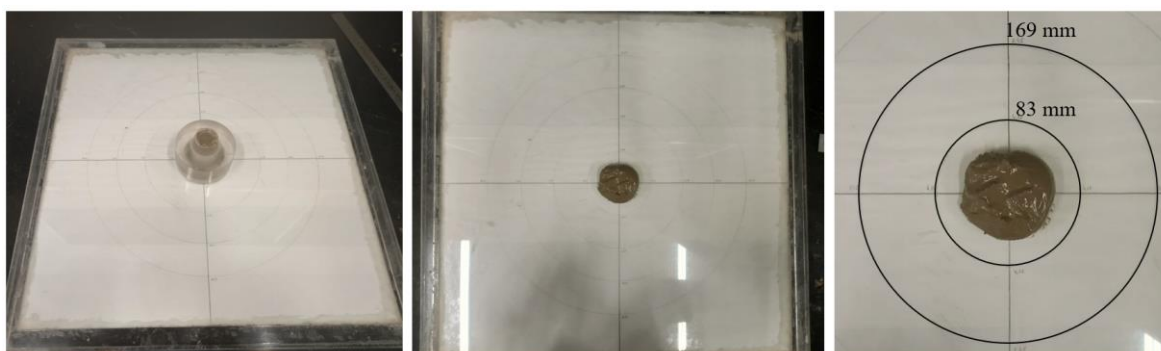
Figura 6. 15 – Ensaio de mini-slump realizado na pasta com 2% de adição de sílica híbrida MTMS (Autora).
