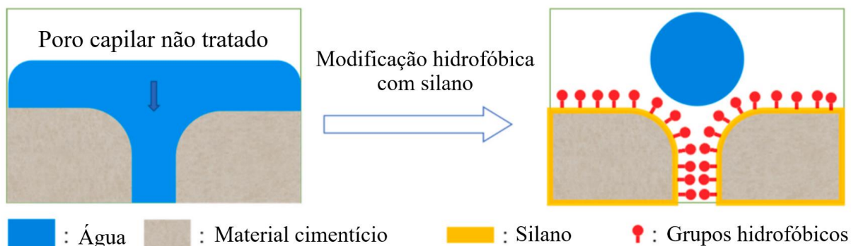
Figura 4. 6 – A superfície hidrofóbica previne a água de entrar no material cimentício pelos poros capilares (Adaptado de LIU et al., 2016)
