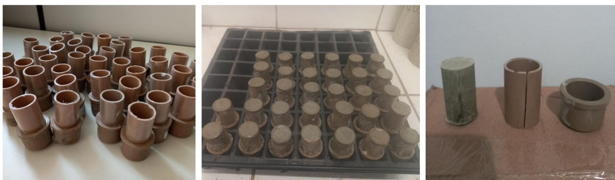
Figura 5. 5 – Moldes de policloreto de polivinila (PVC) de dimensões 20mm x 50mm utilizados na moldagem de todas as amostras da presente tese de doutorado (Autora).
