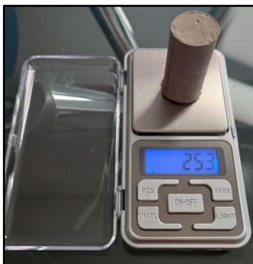
Figura 5. 8 Determinação da massa seca de uma amostra de pasta de cimento por meio de uma balança com 0,1g de precisão (Autora).
