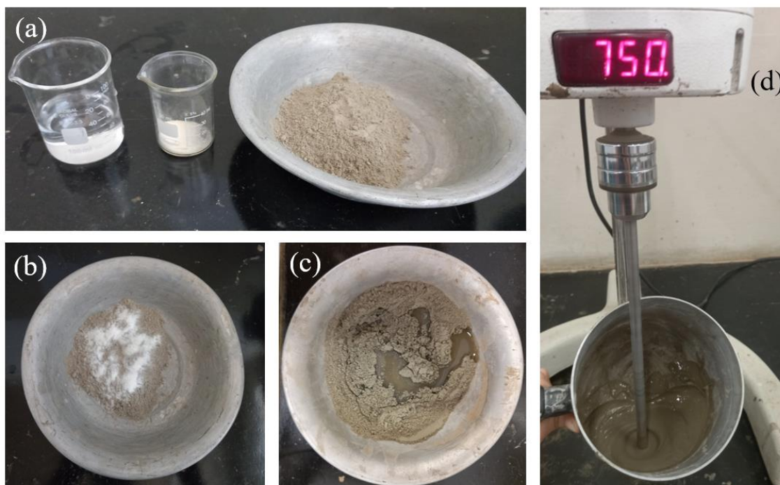
Figura 5. 15– Preparo das pastas de cimento com adição de sílica híbrida MTMS: (a) materiais; (b) homogeneização dos sólidos (cimento e sílica); (c) adição da primeira parte de água; e (d) mistura mecânica por meio de misturador elétrico a 750 rpm (Autora).
