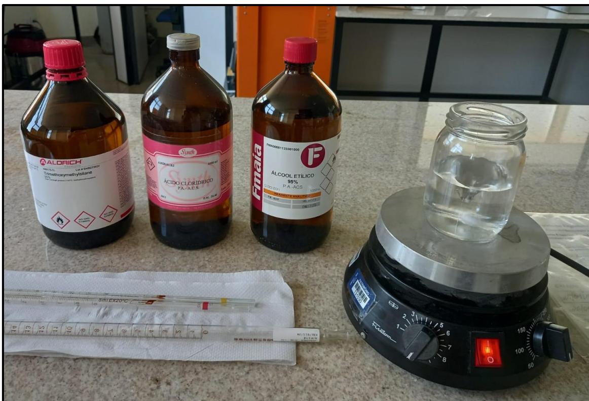
Figura 5. 3 – Síntese de sílica híbrida via rota sol-gel e precursores utilizados no processo (Autora).
