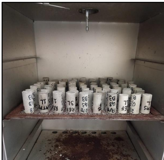
Figura 5. 17 – Amostras de pasta de cimento colocadas para secar em estufa após os 45 dias de exposição, visando a repetição dos ensaios de absorção de água por capilaridade e de medida do ângulo de contato (Autora).
