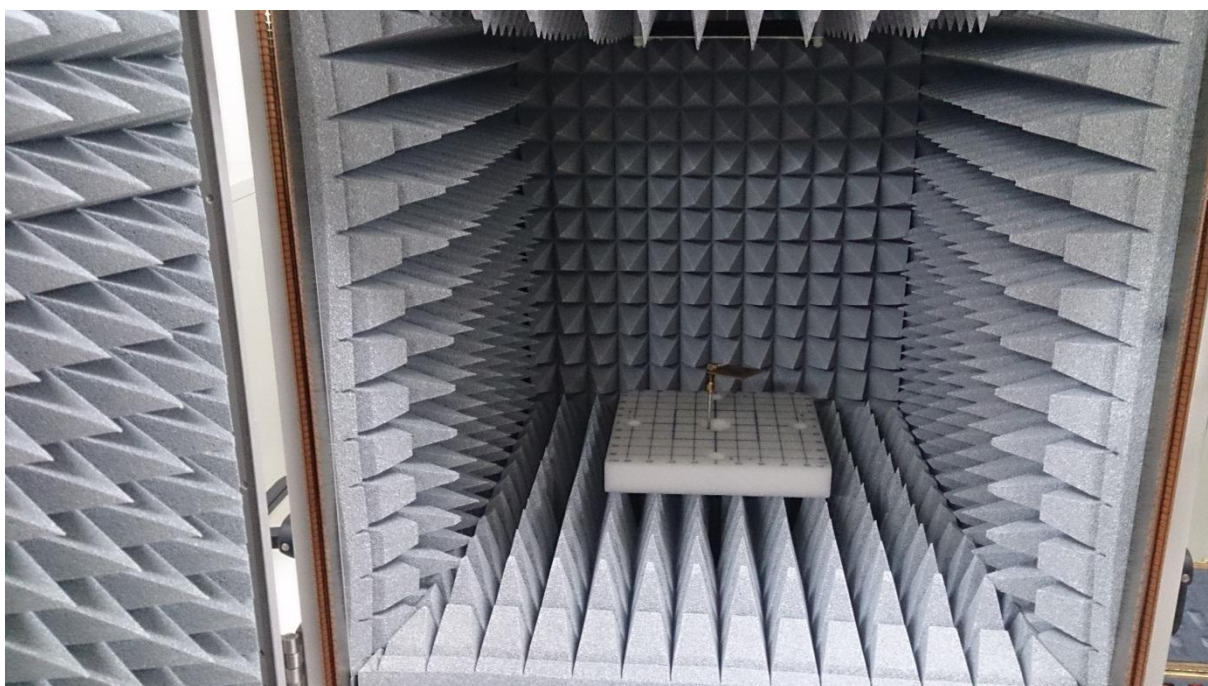
Figura 4.20: Medição da perda de retorno em câmara anecoica da antena projetada construída.
