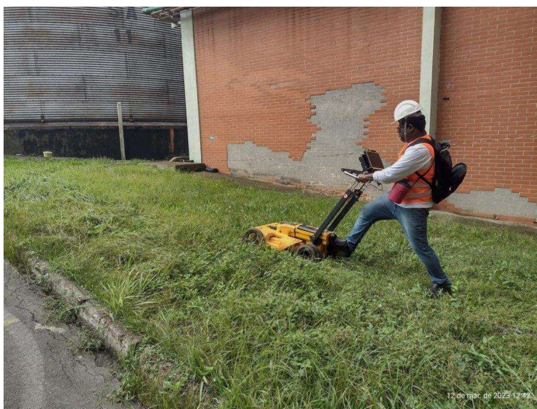
Figura 14 - Passagem do Georadar (Autor)
