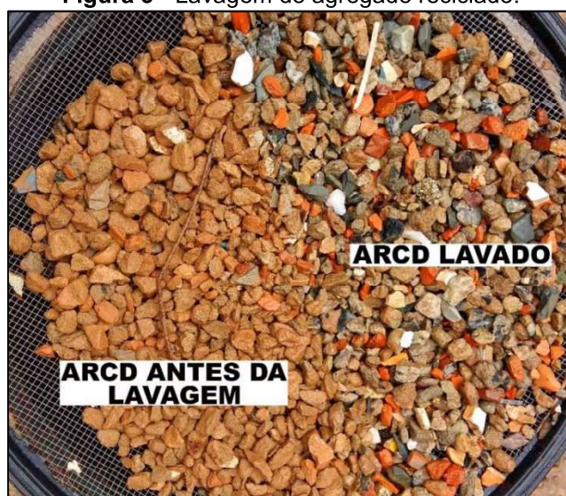
Figura 3 - Lavagem do agregado reciclado.
