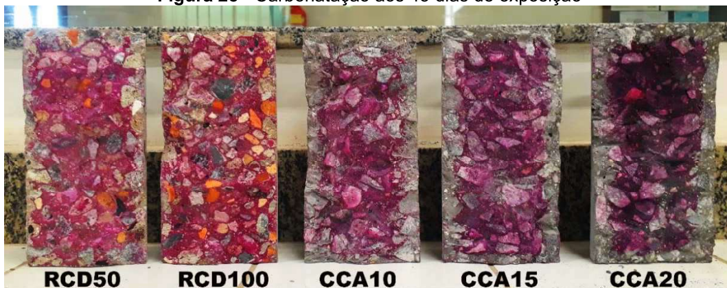
Figura 28 - Carbonatação aos 45 dias de exposição
