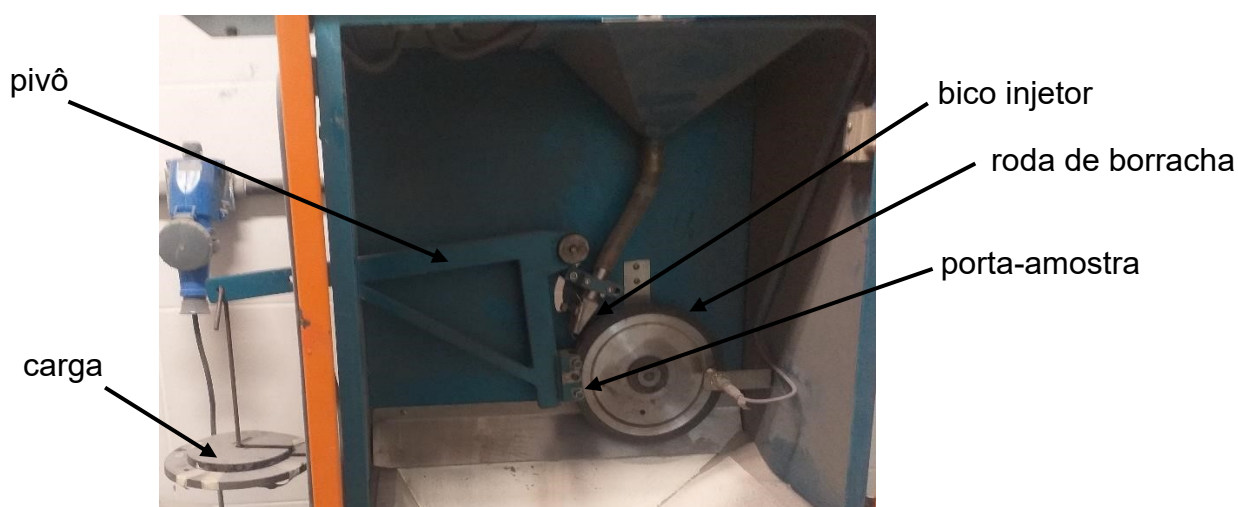
Figura 36 - Desenho esquemático do ensaio de desgaste roda de borracha
