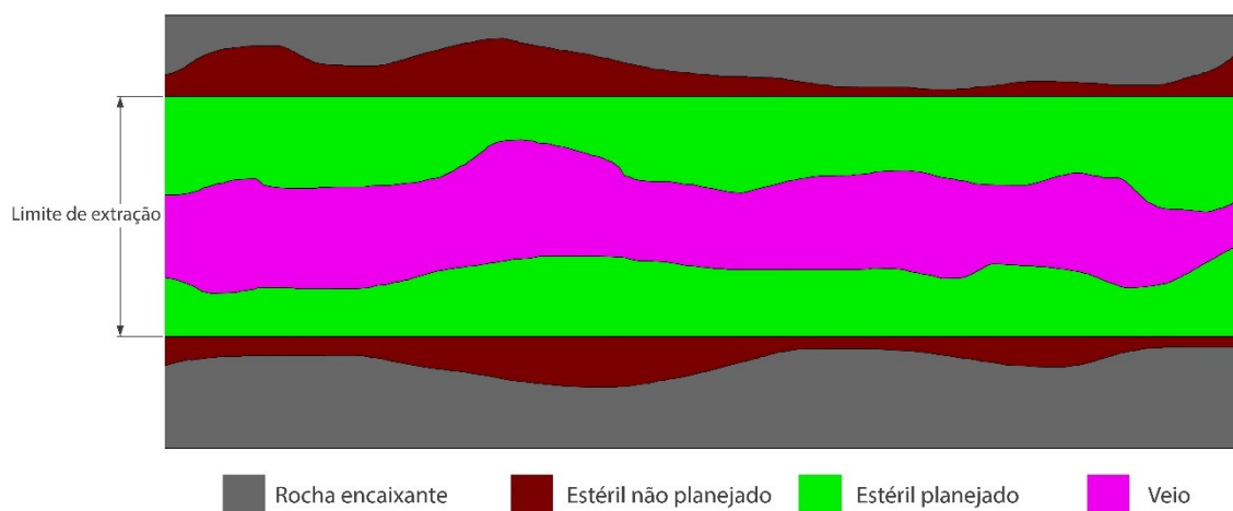
Figura 17 - Representação do maciço rochoso com destaque em uma extração feita fora do esperado
