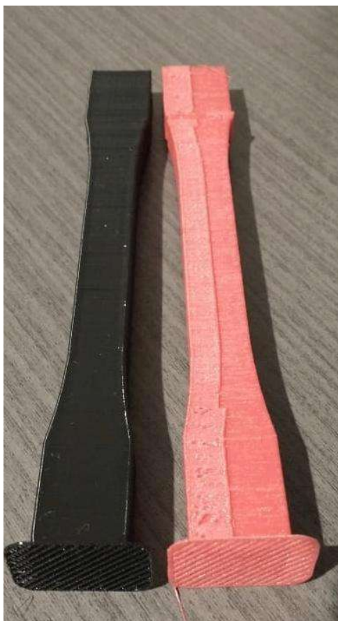
Figura 4.6. – Corpos de prova de PETG nas condições virgem (coloração escura) e reciclado (coloração clara).
