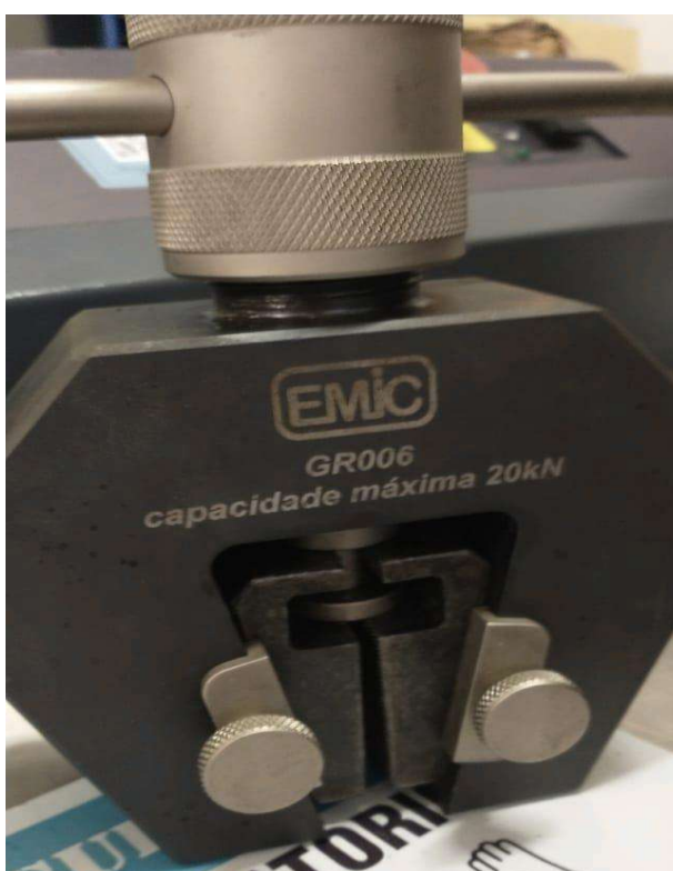
Figura 4.4. – Garras mecânicas modelo GR006 20kN
