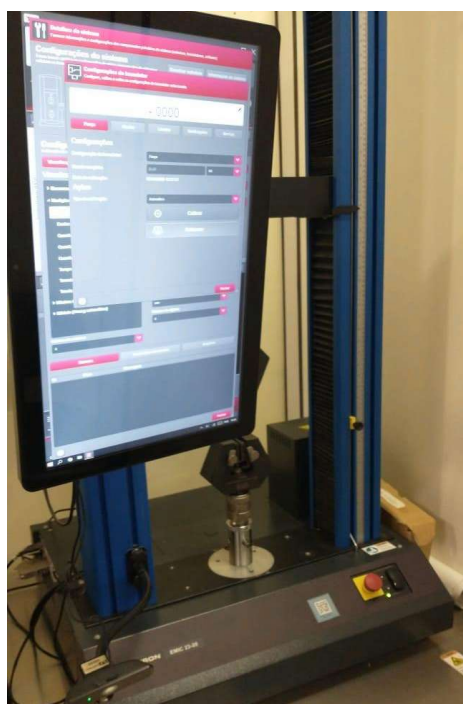
Figura 4.3. – Máquina Universal de Ensaios (MUE) INSTRON EMIC 23-20
