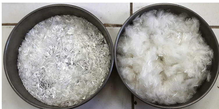
Figura 15 – Aspecto das fibras antes (à esquerda) e após (à direita) a separação manual.
