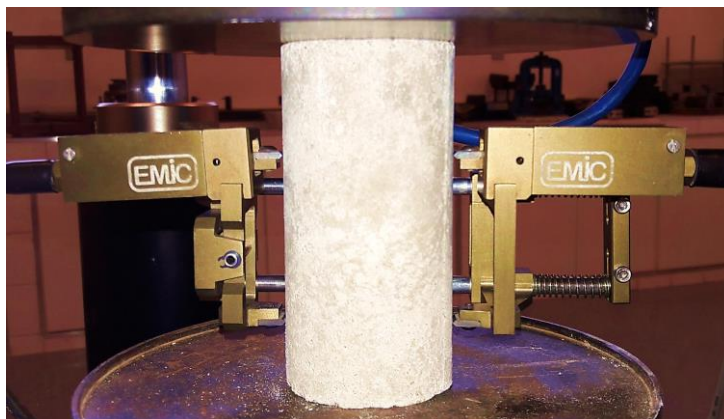
Figura 19 – Montagem do ensaio de módulo de elasticidade.
