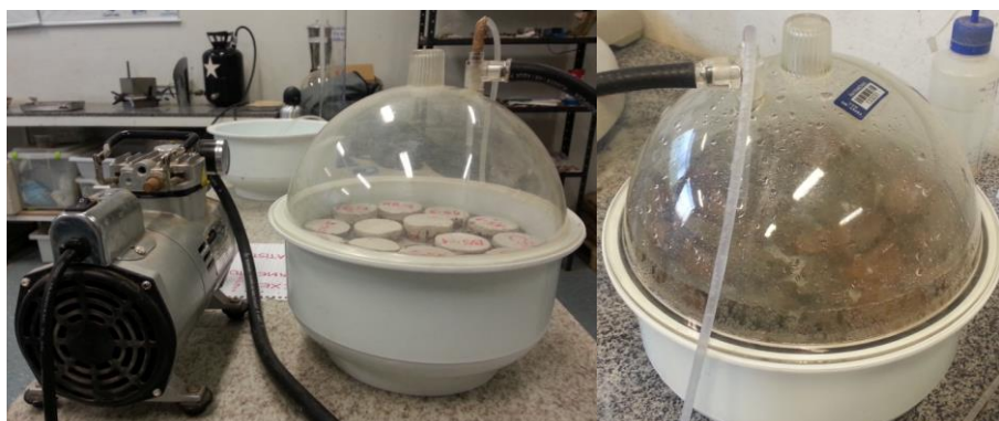
Figura 21 – Dessecador sob vácuo para ensaio de saturação em água.
