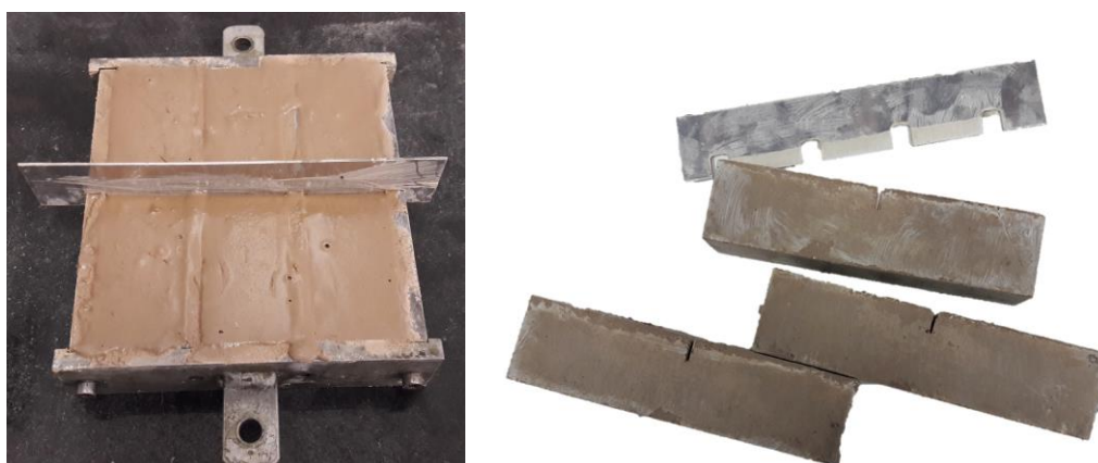
Figura 25 – Moldagem dos corpos de prova com entalhe, chapa de alumínio utilizada para produzir os entalhes e corpos de prova após a desmoldagem.
