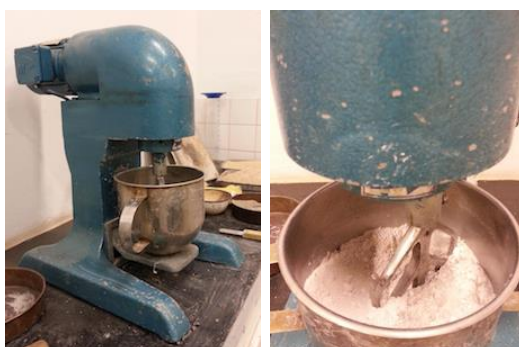
Figura 16 – Preparo das argamassas em argamassadeira de giro planetário.
