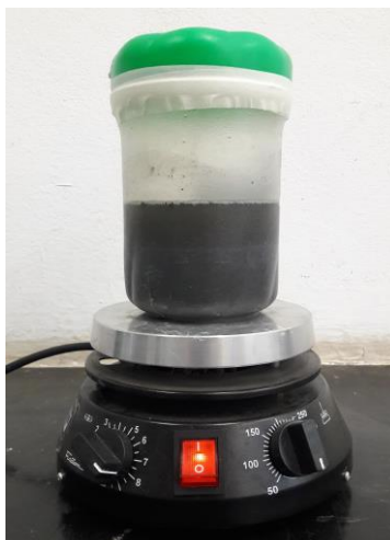
Figura 14 – Dissolução da sílica ativa em hidróxido de sódio.
