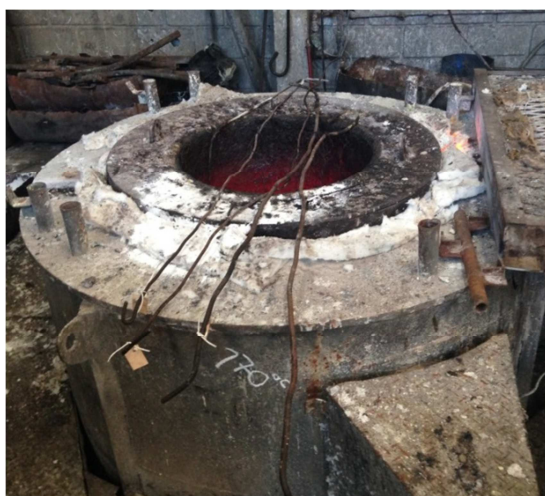
Figura 29: Forno com banho de sal fundido utilizado nos tratamentos térmicos.
