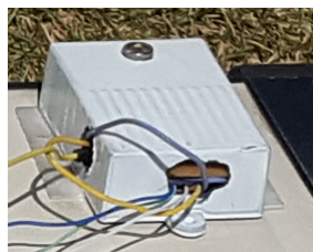
Figura 28 – (a) Montagem do fotodiodo S1223 utilizado para a medição da radiação global e (b) circuito de condicionamento do sinal.
