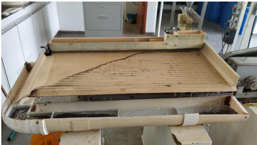
Figura 25 - Mesa concentradora Wilfley utilizada no experimento
