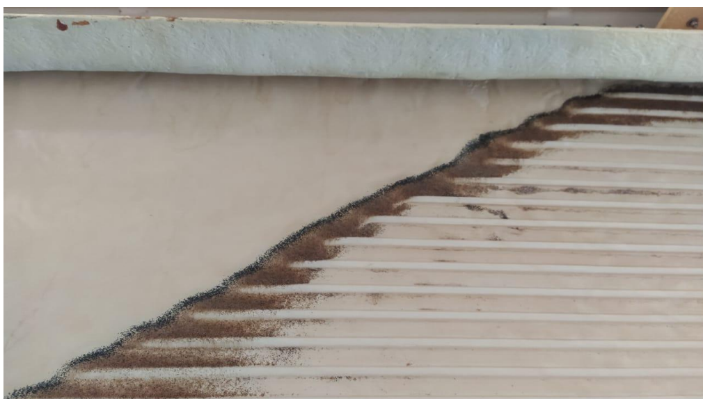
Figura 26 - Diferença entre os minerais mais densos e magnéticos em relação ao mais leves
