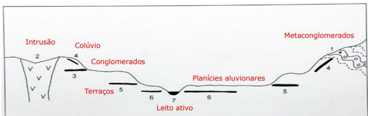
Figura 15 - Tipologia dos depósitos diamantíferos continentais.
