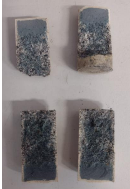
Figura 13 – Corpo de prova partido pelo ensaio por compressão diametral.
