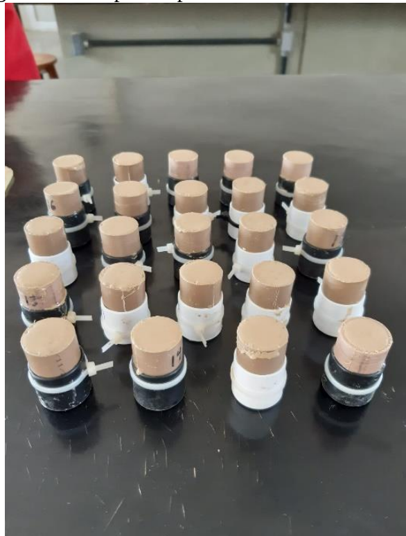
Figura 10 - Corpos de prova ainda nos moldes
