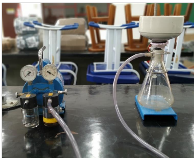
Figura 22 - Equipamentos utilizados no teste de reteno de gua
