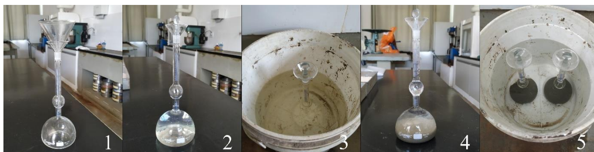
Figura 17 - Determinação da massa específica do cimento
