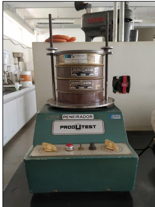
Figura 13 - Peneirador e sequência de peneiras
