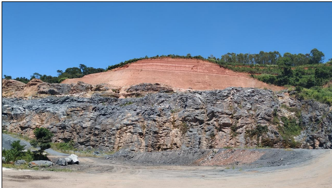
Figura 8 - Bancadas de calcário, estéril e matéria orgânica
