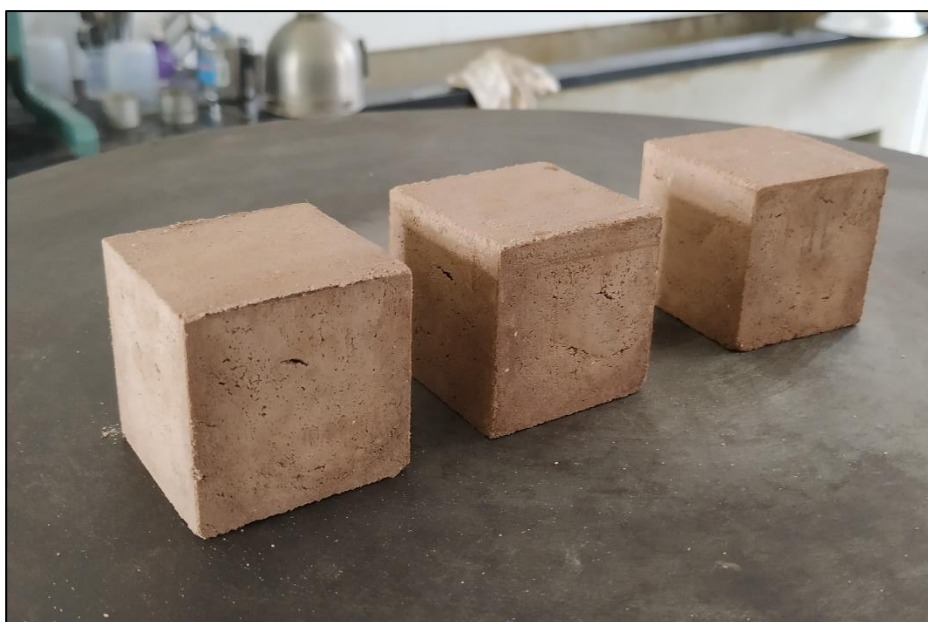
Figura 25 - Copos de prova cúbicos
