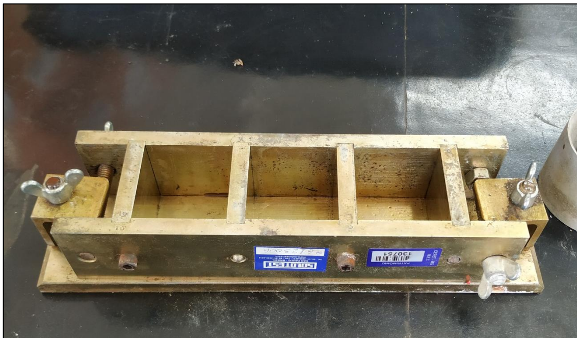
Figura 19 – Molde de corpos de prova cúbicos
