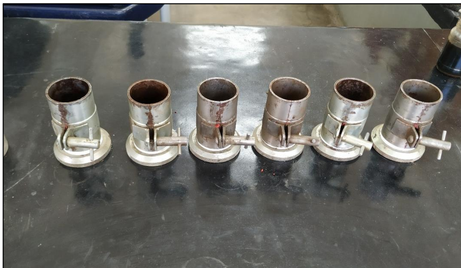
Figura 20 – Molde de corpos de prova cilíndricos
