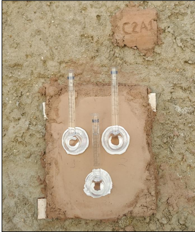
Figura 24 - Teste de permeabilidade na aplicação em parede
