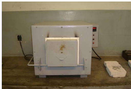
Figura 18 - Forno elétrico marca Magnus empregado nos tratamentos térmicos.
