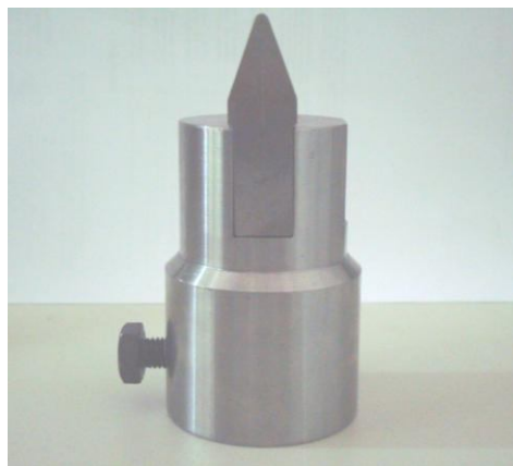
Figura 21 - Punção de 4 mm de raio e suporte usados no dobramento das amostras.
