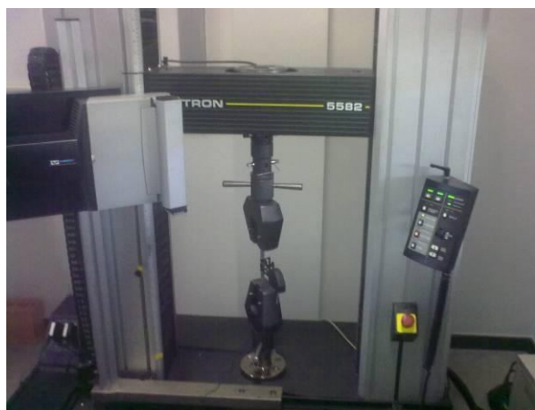
Figura 30 – Máquina universal de ensaios Instron : (a) Vista geral, (b) Detalhe.
