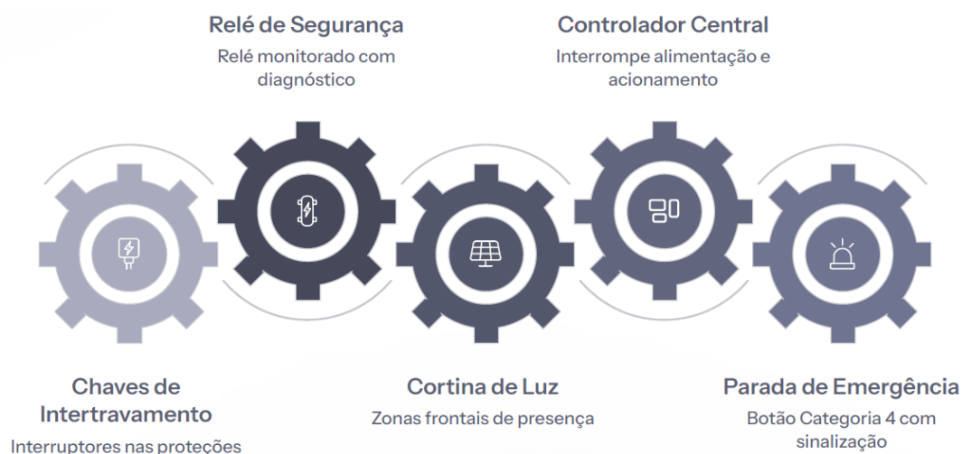
Figura 21 - Arquitetura do Sistema de Segurança
