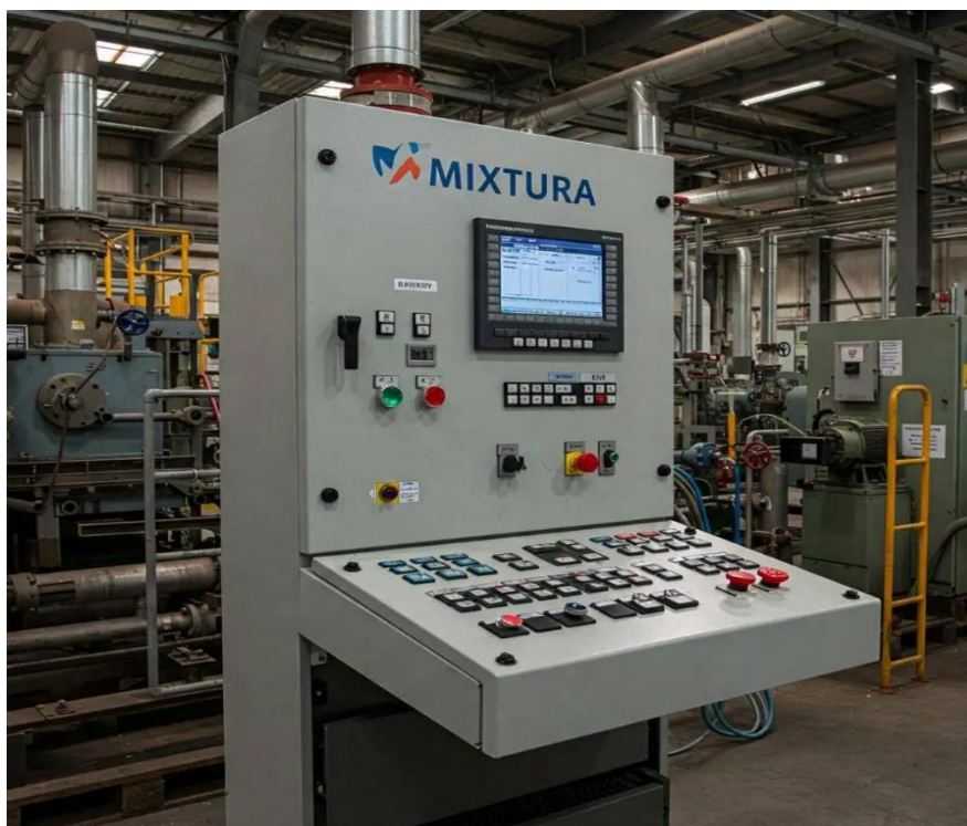
Figura 22 - Exemplo de painel de controle industrial com sistema de comando de segurança
