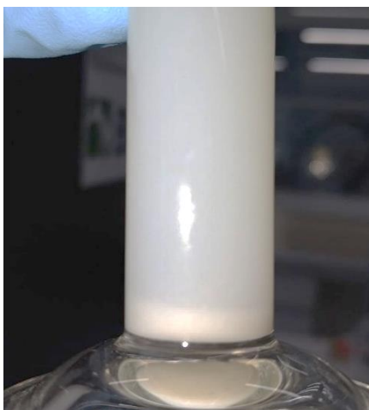
Figura 26: Teste de estabilização com ajuste de pH. A foto mostra a leitura 1h e 30min após o preparo da emulsão. O pH da emulsão ao final da preparação era de 3,06, e foi ajustado para 5,74 (Composição: 15% de cocoamidopropil betaína, 5% de tween 20, 0,25% de PPI, 5% de óleo de jojoba e q.s.p. água ultrapura).
