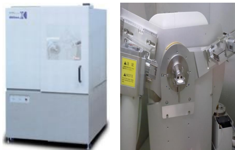
Figura 5. 3 - Difratorômetro de raios x com destaque para o porta amostra
