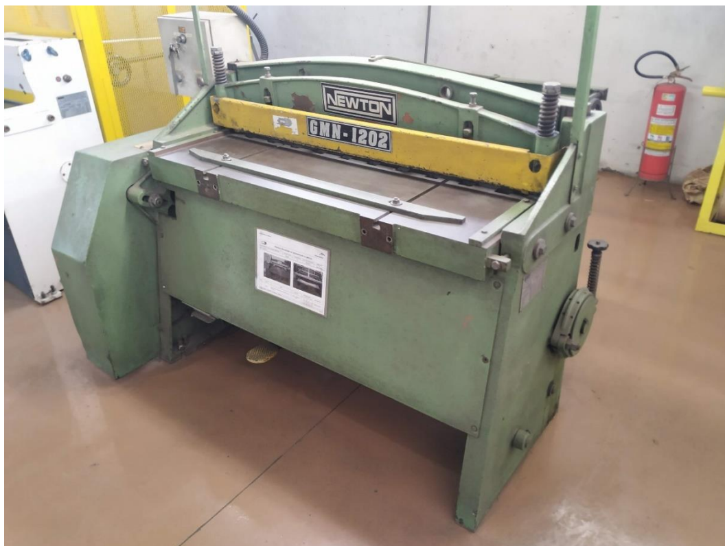
Figura 18 - Tesoura industrial com marca e modelo, dedicada ao corte de amostras no centro de pesquisas da Aperam.
