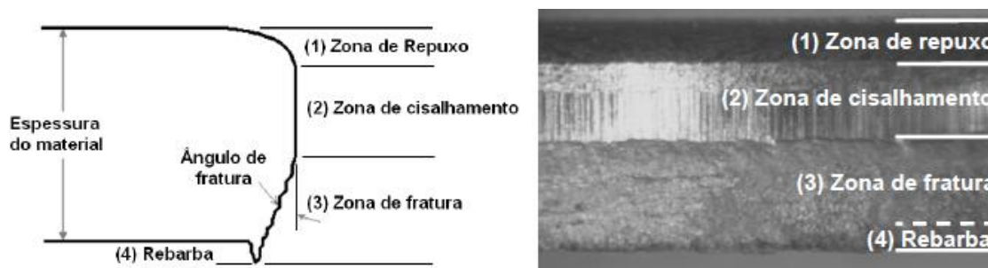
Figura 13 - Principais zonas da superfície de corte de uma lâmina de aço.
