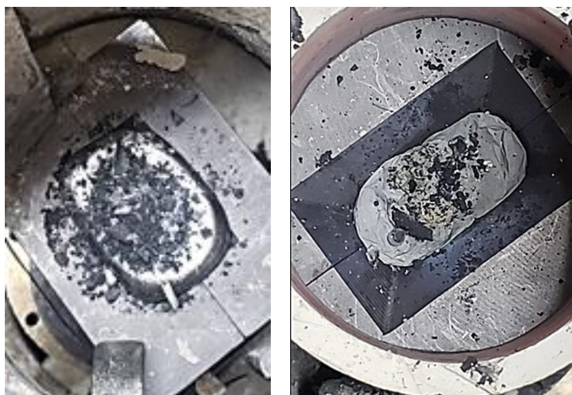
Figura 47 – Grafeno residual no topo do lingote com 2% GNP em corridas exploratórias. A) sem agitação mecânica; B) com agitação mecânica
