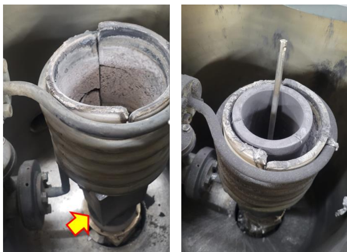
Figura 43 – A) Molde sob a bobina; B) Posicionamento do cadinho e haste de agitação
