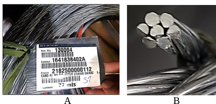
Figura 35: Cabo alumínio comercial 1350 EC H19, A) Rolo, B) Seção do cabo;
