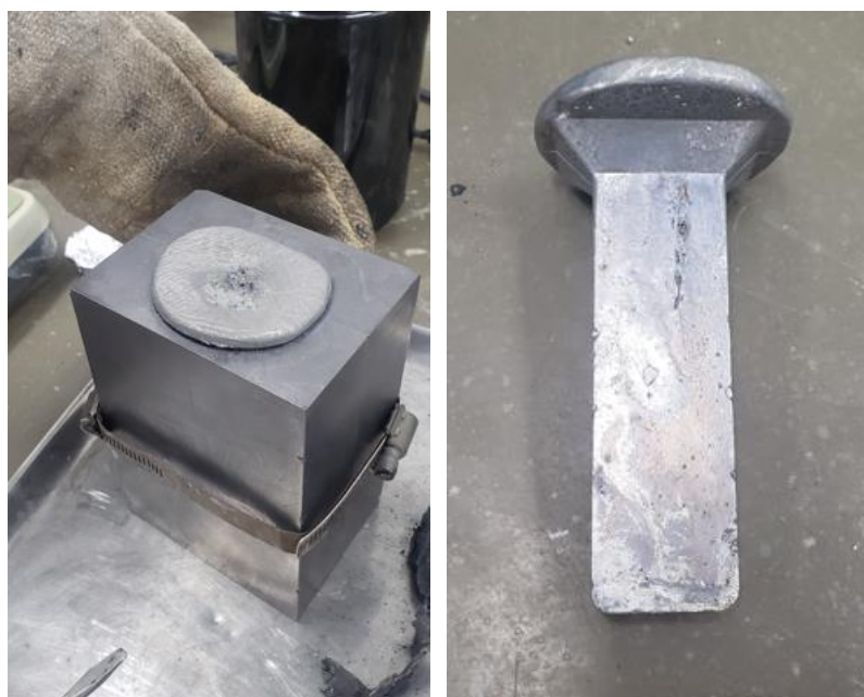
Figura 48 – Desmoldagem. A) Molde montado como extraído do forno; B) Lingote fundido.
