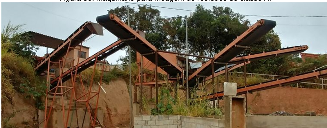
Figura 36: Maquinário para moagem de resíduos de classe A.
