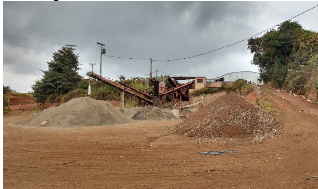
(b) Vista do britador de resíduos e esteiras para depósito de materiais granulares obtidos na moagem
