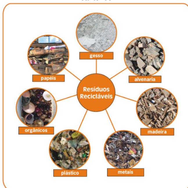
Figura 13: Tipos de resíduos que devem ser coletados e armazenados em local específico nos canteiros.
