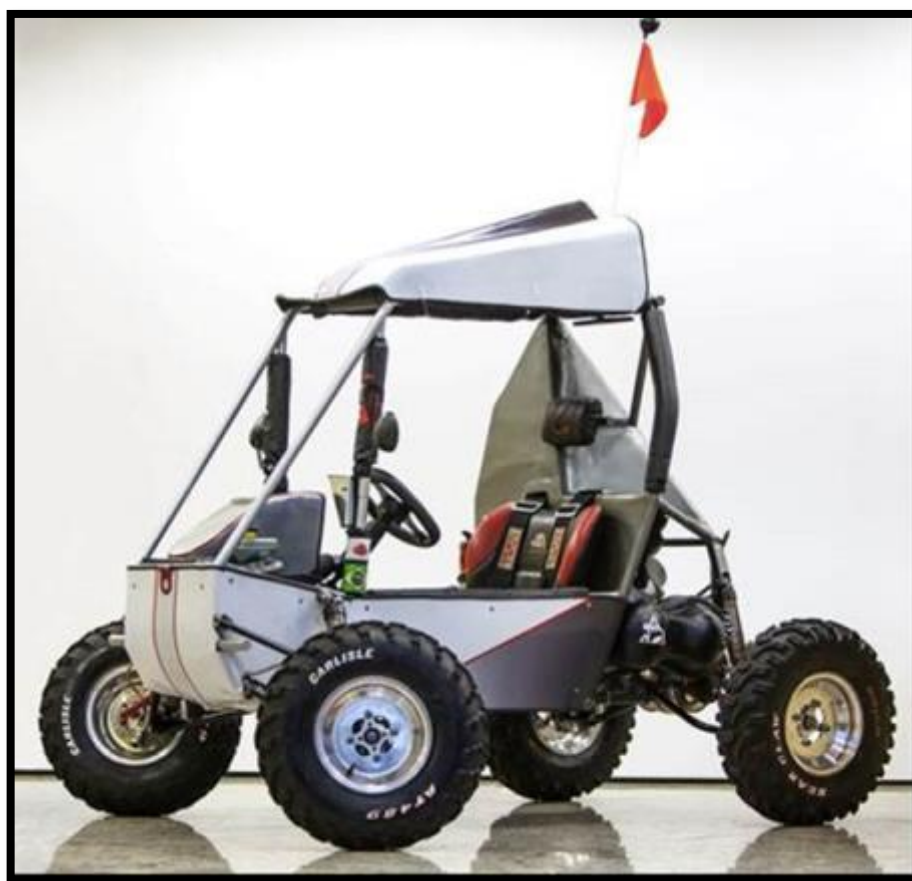
FIGURA 1 – Protótipo do Veículo CEFAST BAJA
