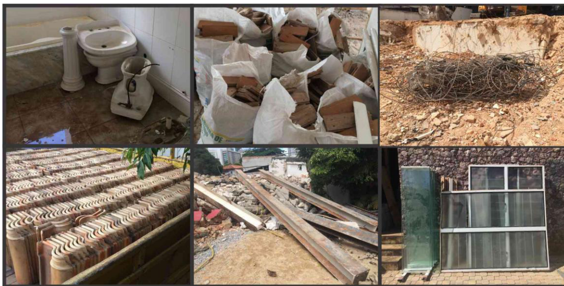
Figura 28 – Resíduos de demolição recuperados
