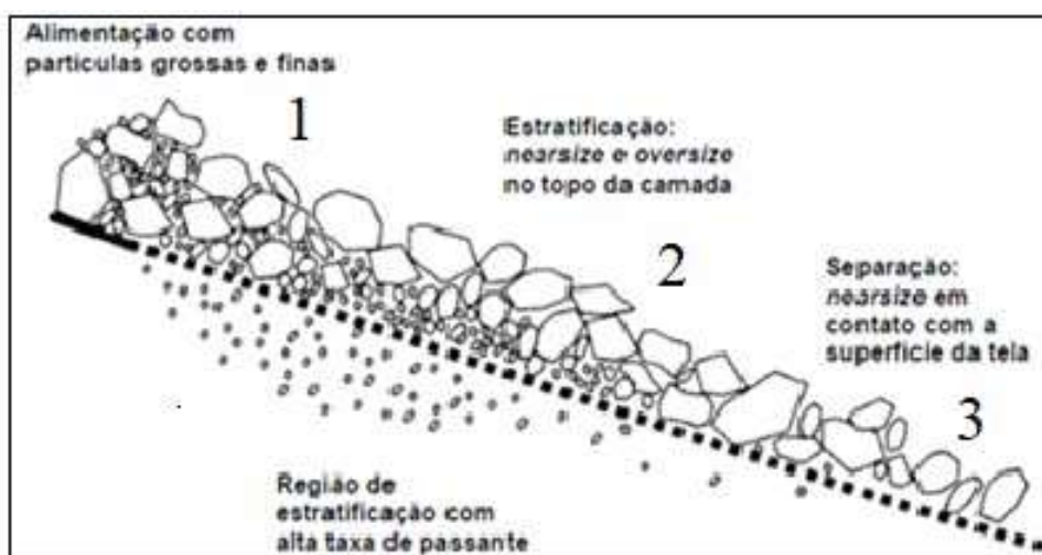
Figura 10: Mecanismos de peneiramento.
