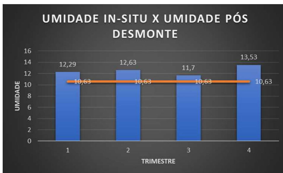
Figura 62: Gráfico da umidade in situ X umidade pós-desmonte.
