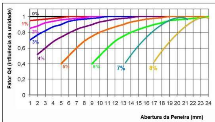
Figura 34: Fator de umidade em função da abertura da peneira
