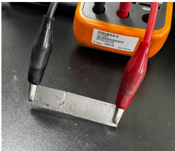
Figura 19 - Medição dos corpos de prova através de ponte LCR portátil
