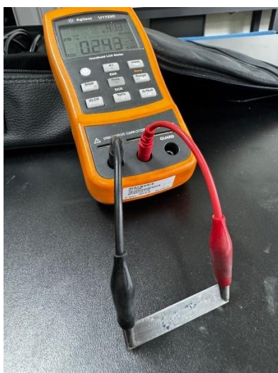
Figura 19 - Medição dos corpos de prova através de ponte LCR portátil
