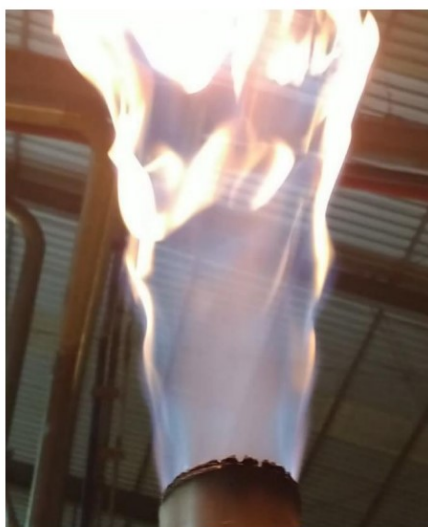
Figura 26 – Chama do flare com gás de síntese
