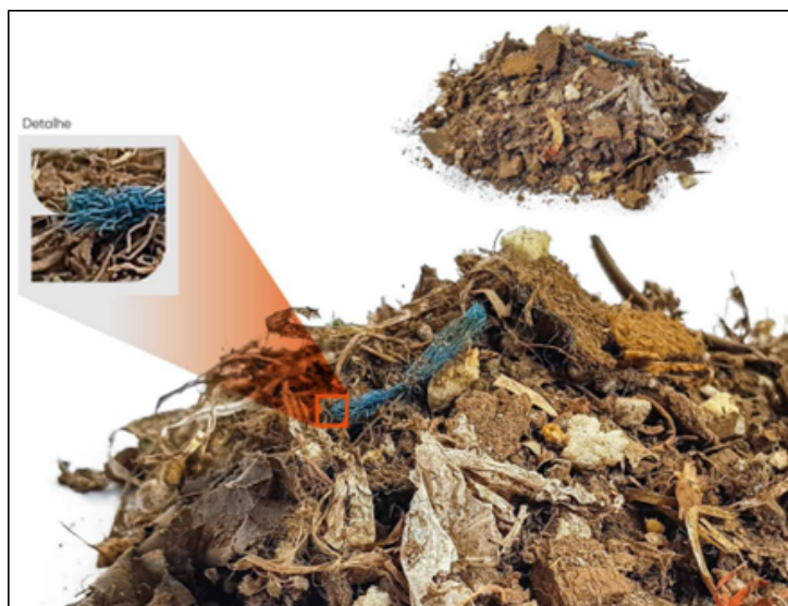
Figura 5 – Imagem ampliada de resíduos da Shredder
