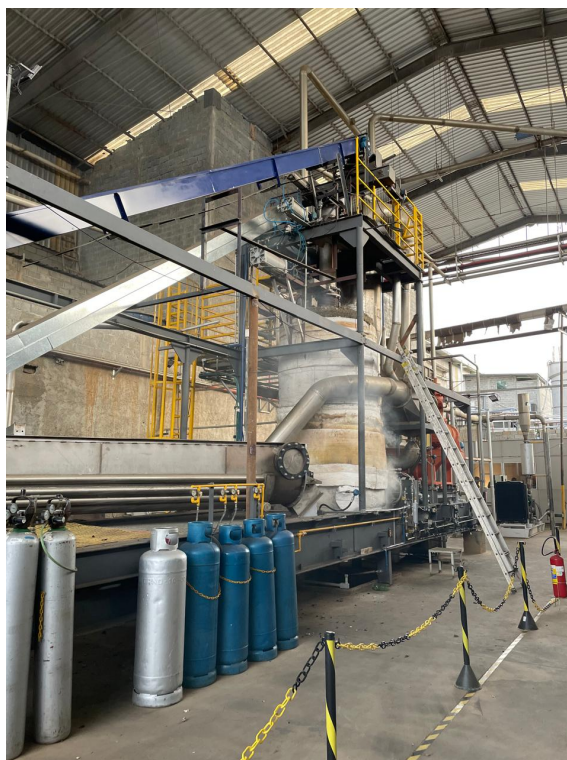
Figura 18 – Gaseificador semi-industrial utilizado para realização dos testes
