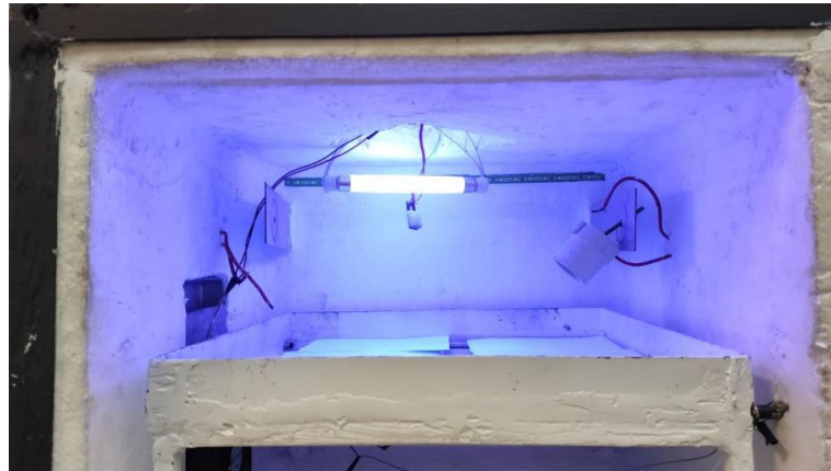
Figura 21- Detalhe da fonte de radiação: lâmpada UV-A (4W, 365 nm)
