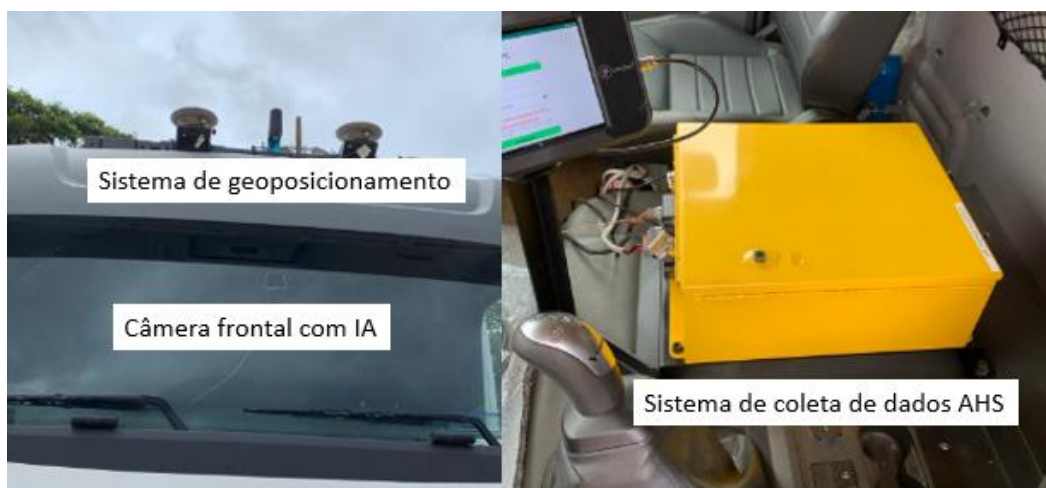
Figura 17 – Componentes do caminhão autônomo
