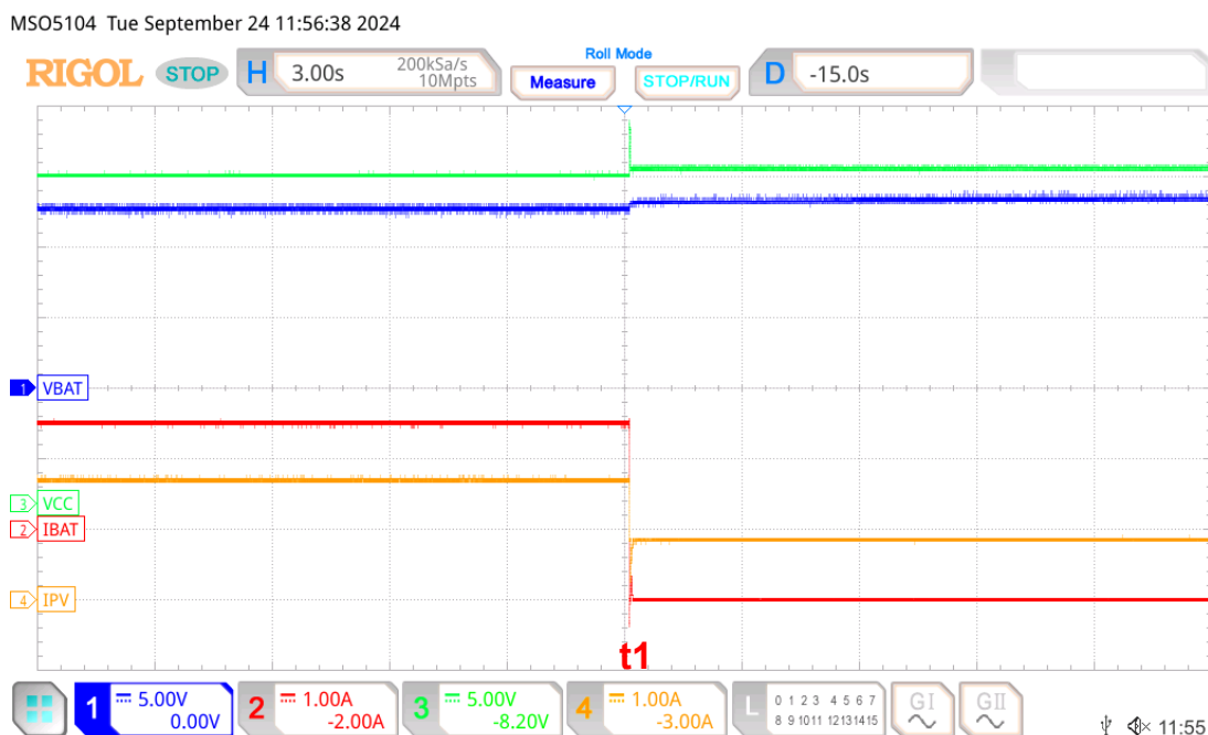
Figura 3.9 – Retirada abrupta de toda a carga do sistema com painel fotovoltaico e bateria.
