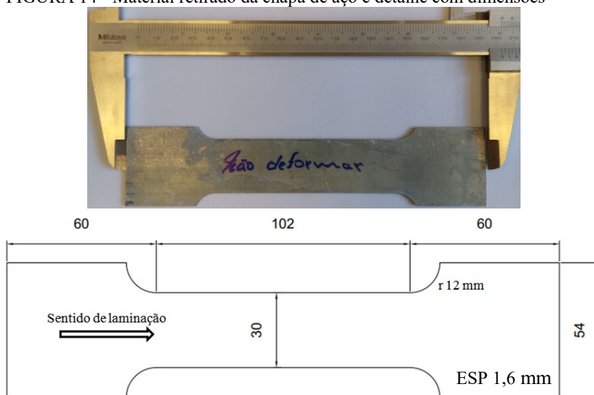
FIGURA 14 - Material retirado da chapa de aço e detalhe com dimensões
